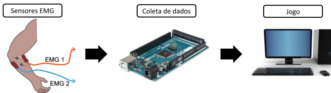
Figura 21 – Esquema da arquitetura do sistema PhysioPong.
