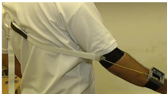
(a) Estrutura do tirante com sensores
