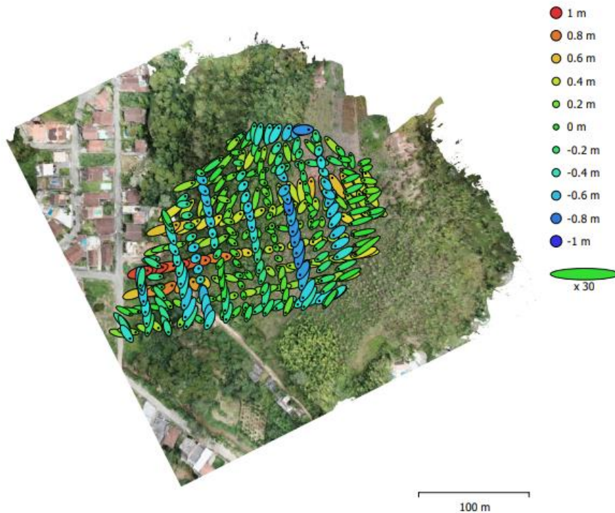
Figura 13- Exemplo da localização da câmera do drone e estimativas de erros.
