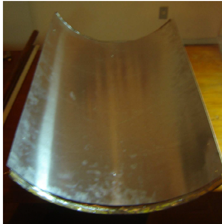
FIGURA 20 - Chapa de alumínio presa a base de latão
