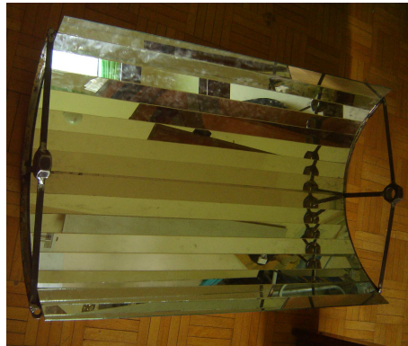
FIGURA 24 - Concentrados já com as hastes de suporte do tubo absorvedor
