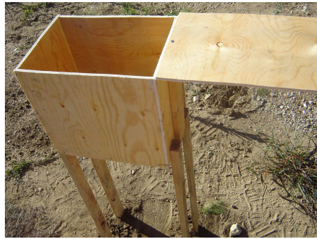
FIGURA 30 - Suporte para o reservatório térmico
