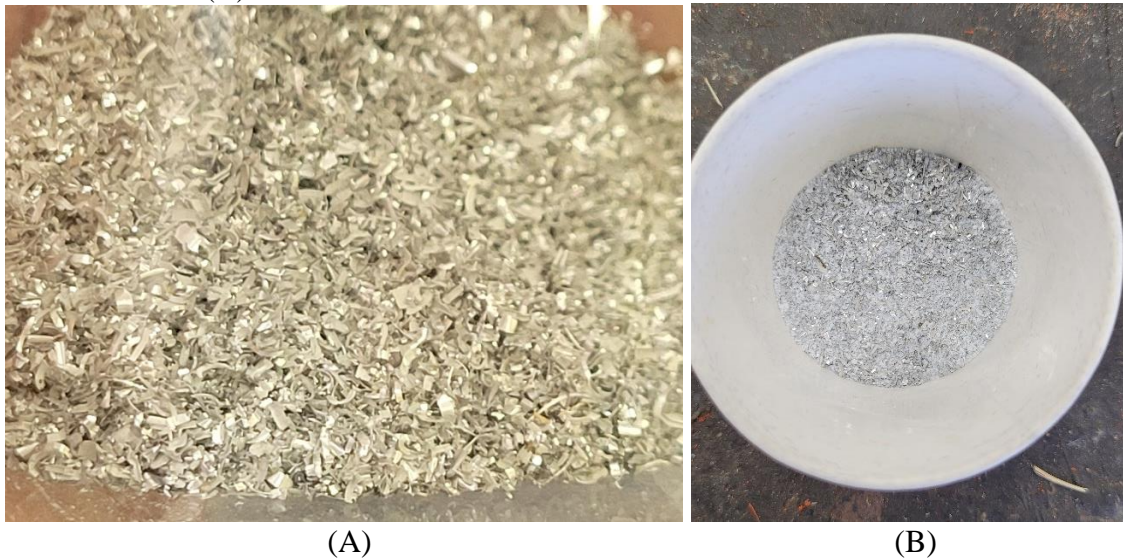
Figura 21 – Limalha de alumínio (A) e cadinho utilizado para redução com a mistura sílica/alumínio (B).
