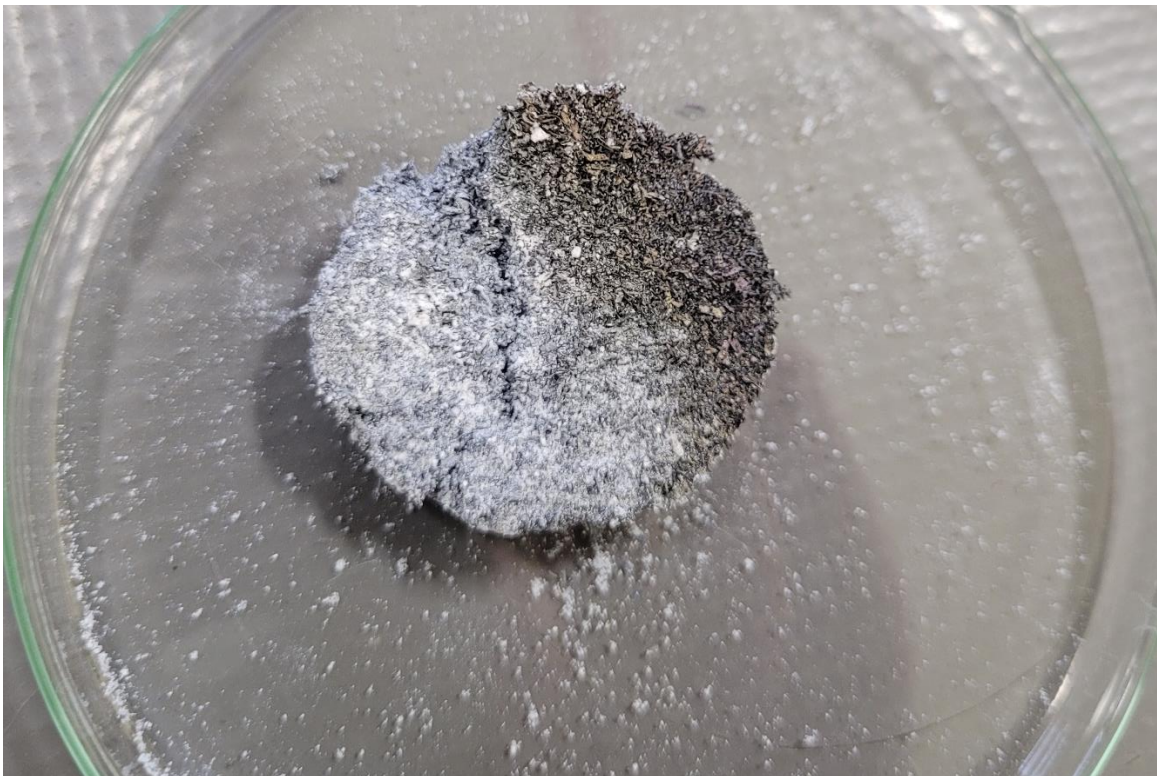
Figura 33 – Material pós redução sem a camada superior de sílica, após ser retirado do forno
