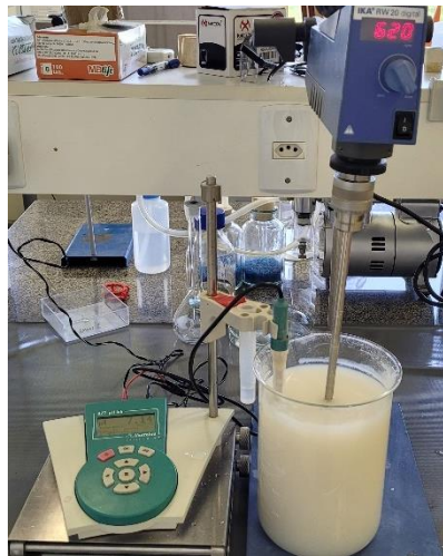
Figura 19 – Disposição utilizada para neutralização e consequente formação do gel de sílica
