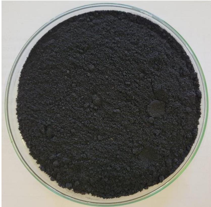
Figura 26 – Cinza residual pós digestão alcalina
