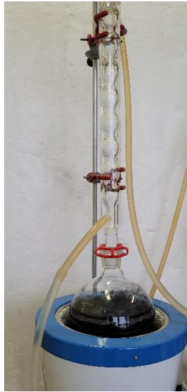
Figura 18 – Disposição utilizada na digestão alcalina da CCA lixiviada
