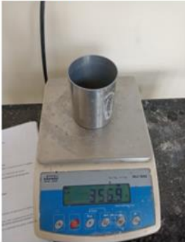
Figura 12 – Equipamentos e procedimentos para execução do ensaio de densidade de massa e teor de ar incorporado.
