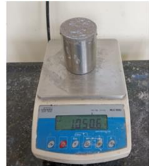
Figura 12 – Equipamentos e procedimentos para execução do ensaio de densidade de massa e teor de ar incorporado.
