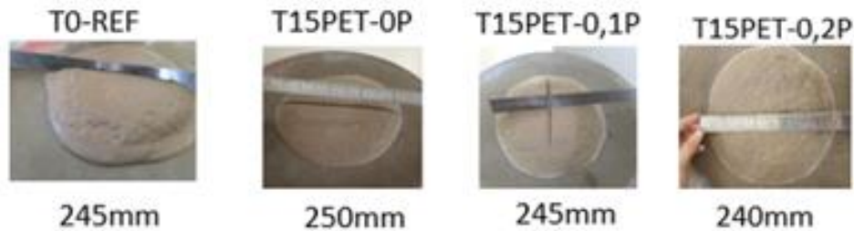
Figura 18 – Determinação do índice de consistência das argamassas.
