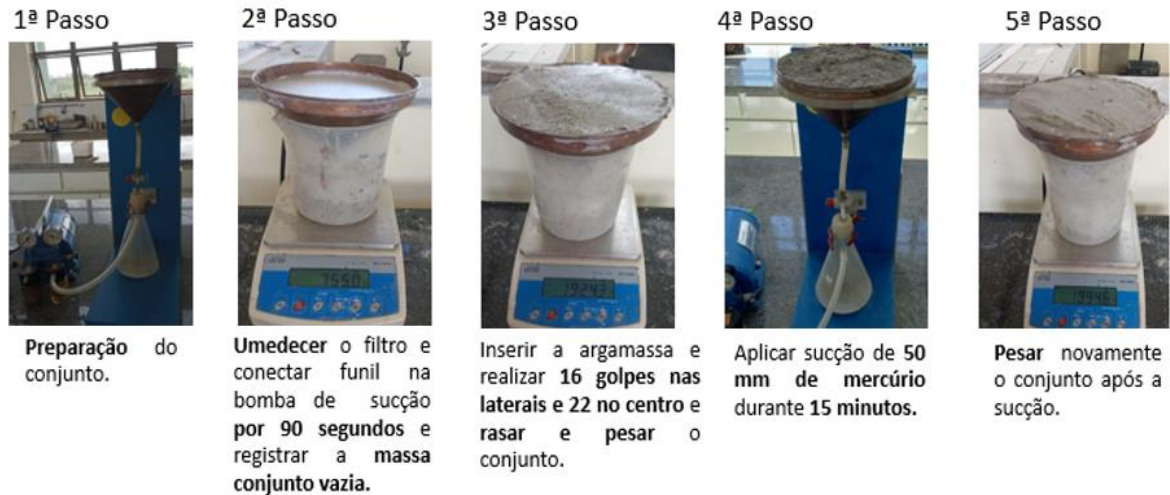
Figura 13- Equipamentos e procedimentos do ensaio de Retenção de água.
