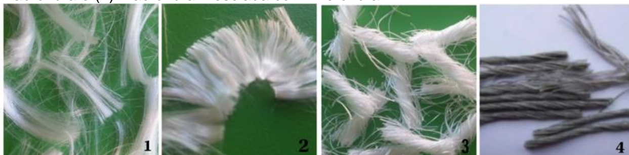
Figura 2- Tipos de Fibras de Polipropileno - (1) Fibrilados, (2) Monofilamento, (3) Macrofibra e (4) Macrofibra mesclada com microfibra 1
