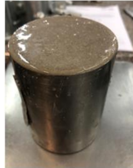
Figura 12 – Equipamentos e procedimentos para execução do ensaio de densidade de massa e teor de ar incorporado.
