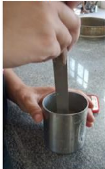
Figura 12 – Equipamentos e procedimentos para execução do ensaio de densidade de massa e teor de ar incorporado.
