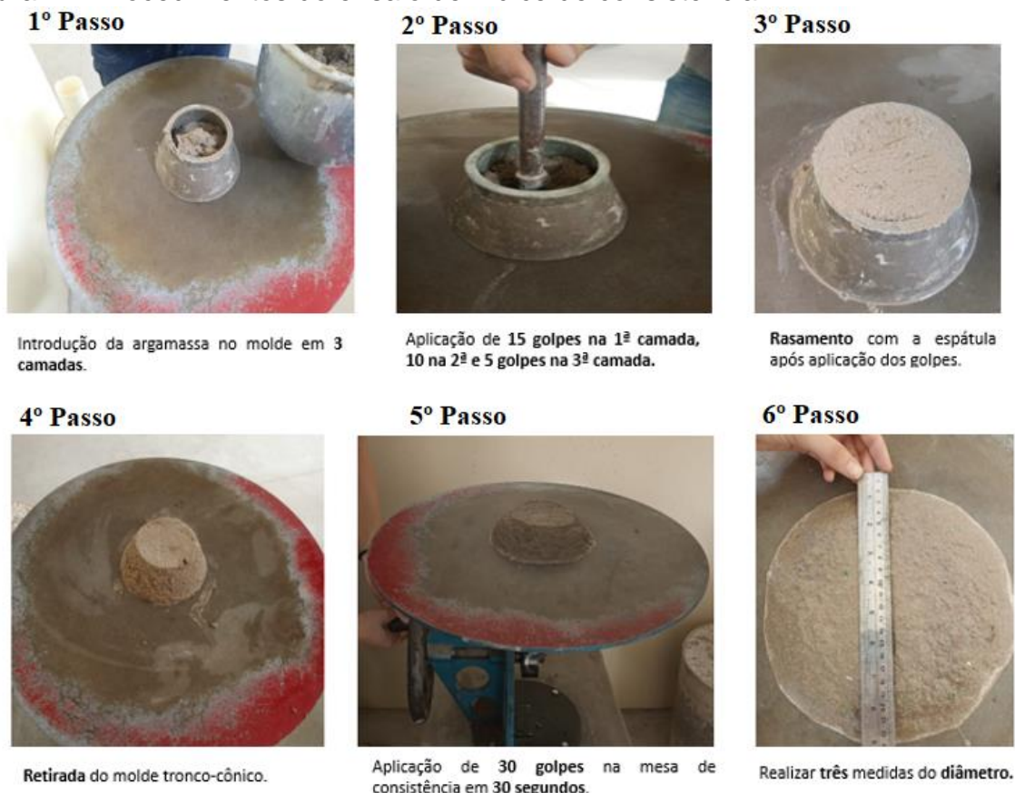
Figura 11- Procedimentos do ensaio de Índice de consistência.
