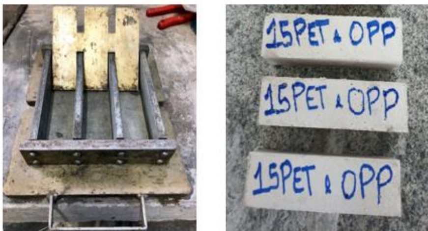
Figura 10 – Moldes prismáticos utilizados na moldagem das argamassas e os corpos de prova após a desmoldarem.
