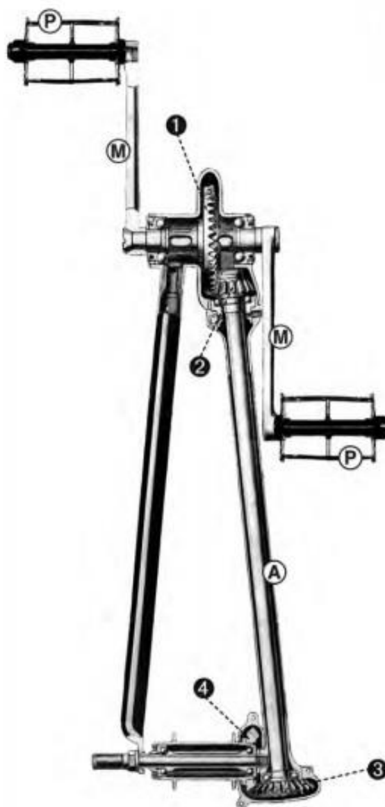
Figura 15 - Transmissão por engrenagens de dentes retos.
