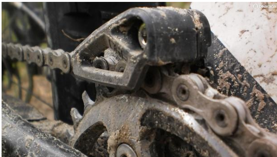
Figura 23 - Guia de corrente após o teste.
