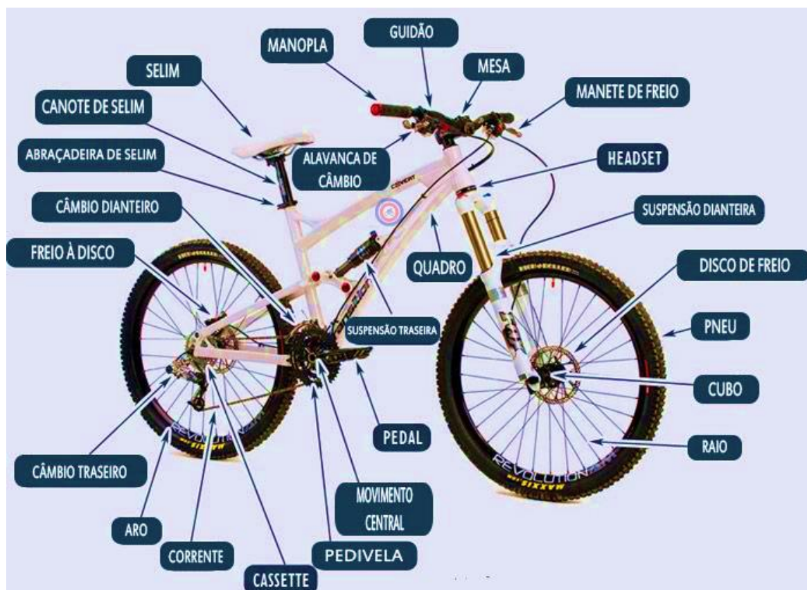
Figura 14 - Partes de uma bicicleta (modelo full-suspension ).
