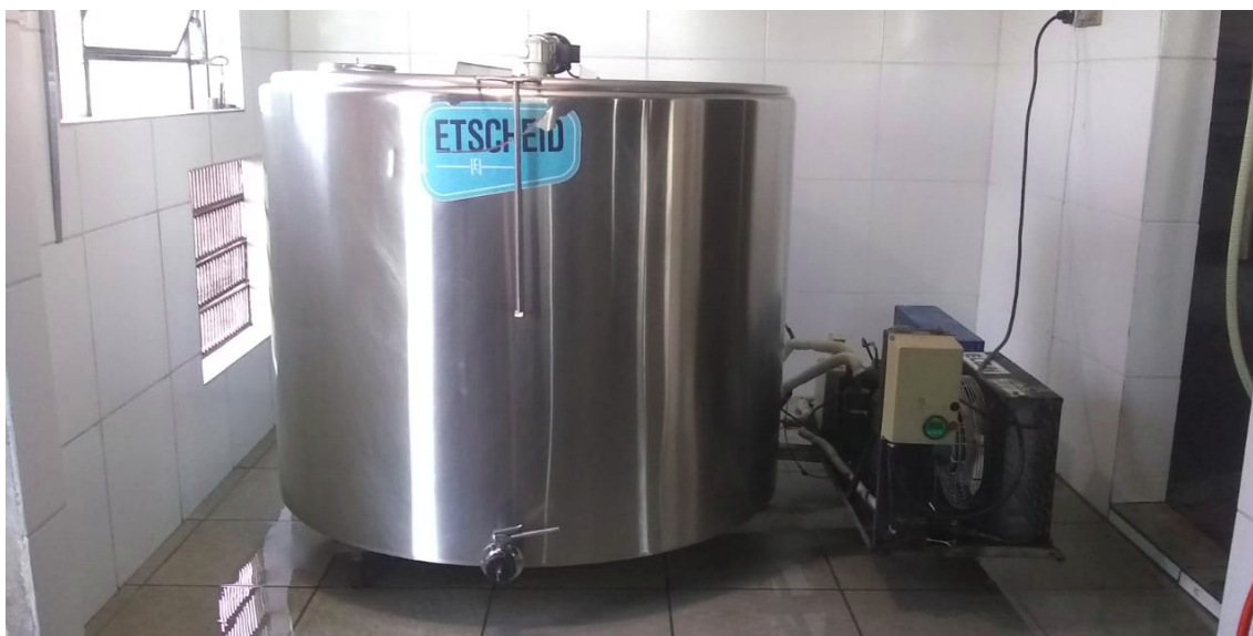
Figura 10 – Tanque de resfriamento
