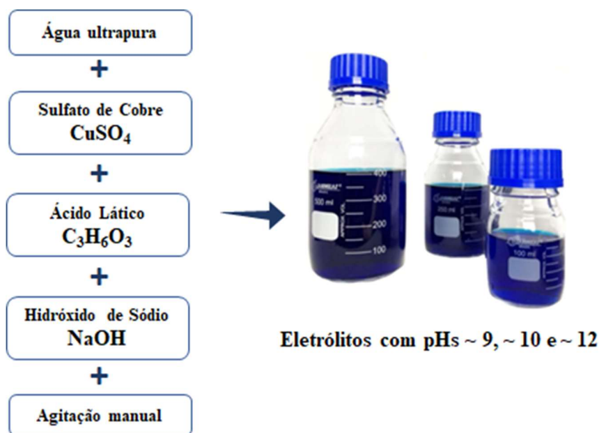
Figura 12 - Esquema de preparação das soluções eletrolíticas
