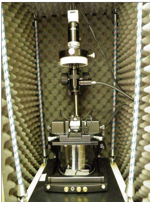
Figura 18 - Microscópio de força atômica Agilent, modelo 5500
