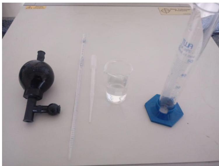
Figura 17 - Materiais utilizados para realização da medida da densidade dos vidros produzidos.
