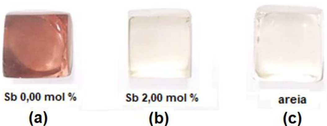
Figura 18- Imagens de três vidros produzidos, onde pode ser observado a mudança de coloração com a adição de \text{Sb}_2\text{O}_3
