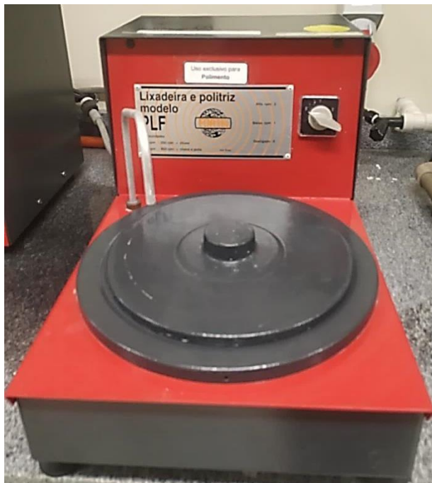
Figura 14 - Politriz utilizada no processo de preparação da amostra.
