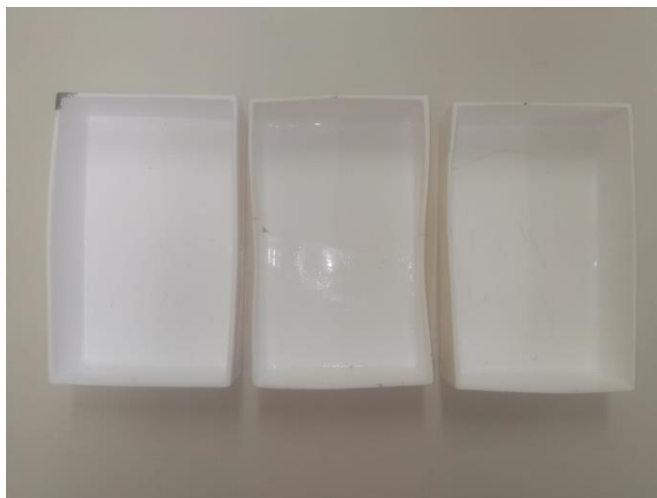
Figura 6 - Bandejas de alumina utilizada em todo processo de obtenção da cinza.
