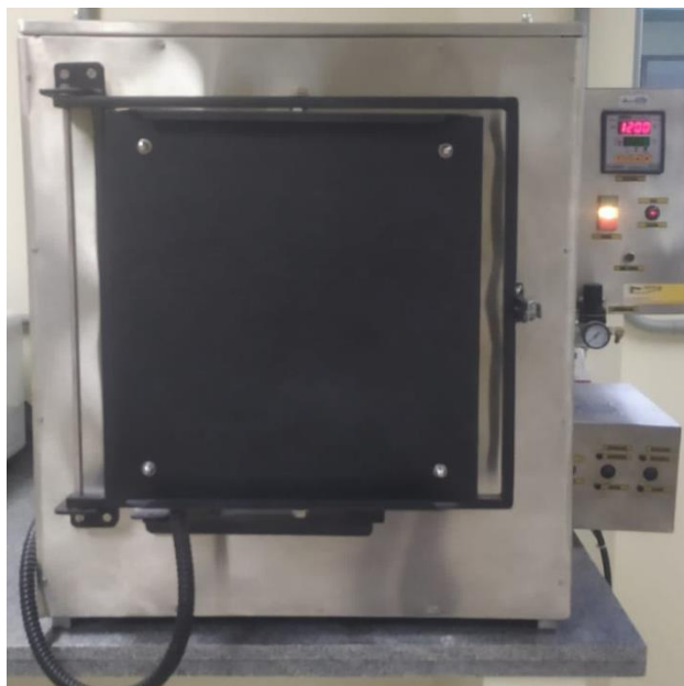
Figura 12 - Forno mufla utilizado para fundição dos vidros.
