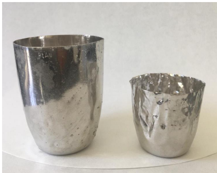
Figura 11 - Cadinhos de Platina utilizados na fusão dos vidros.
