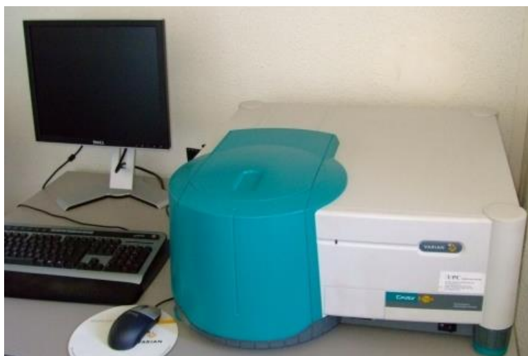
Figura 16 - Espectrômetro de fluorescência utilizado para analisar os vidros fabricados
