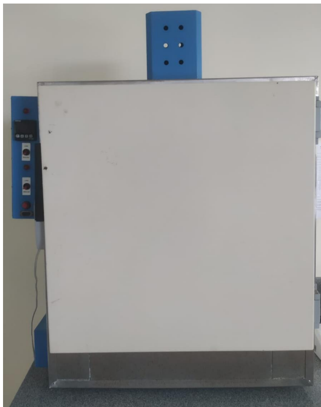
Figura 7 - Estufa utilizada para retirada de umidade da casca.
