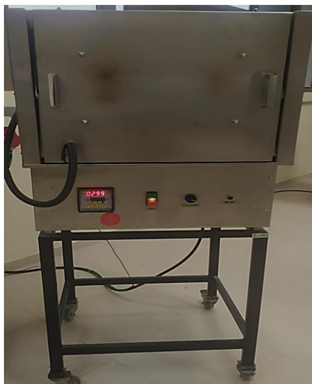
Figura 8 - Forno Mufla utilizado para o processo de queima da CA e onde foram mantidos os moldes dos vidros.
