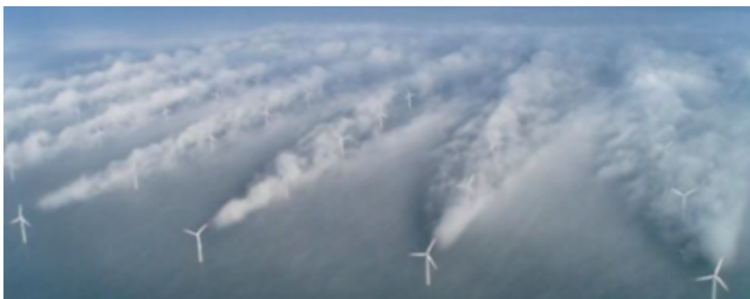
Figura 4 – Efeito esteira em um parque eólico na Dinamarca
