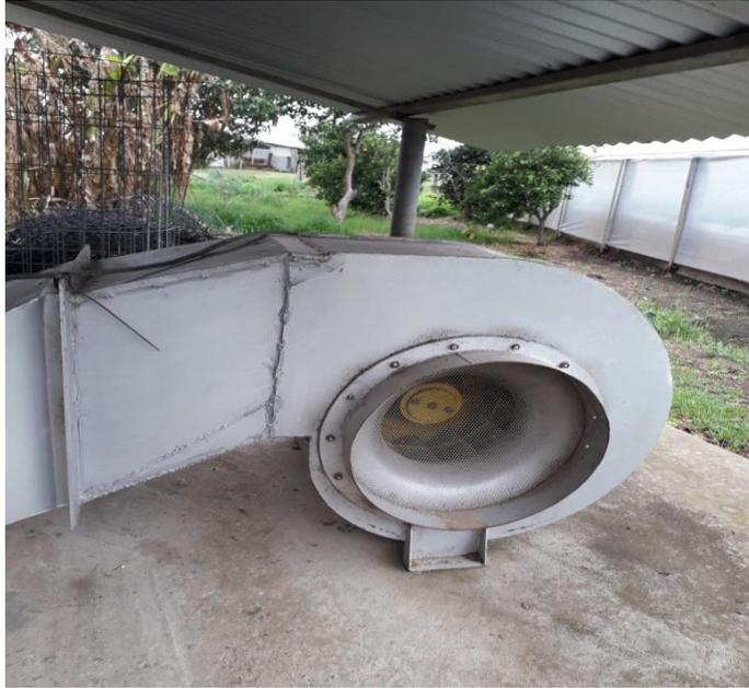
Figura 23 – Ventilador centrífugo radial.
