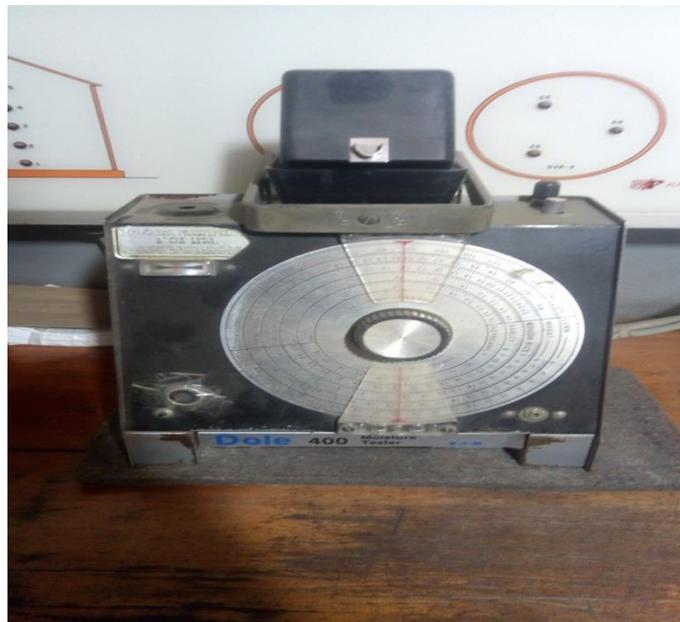
Figura 25 – Medidor de umidade por resistência elétrica.
