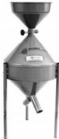
Figura 15 - Homogeneizador de amostra.
