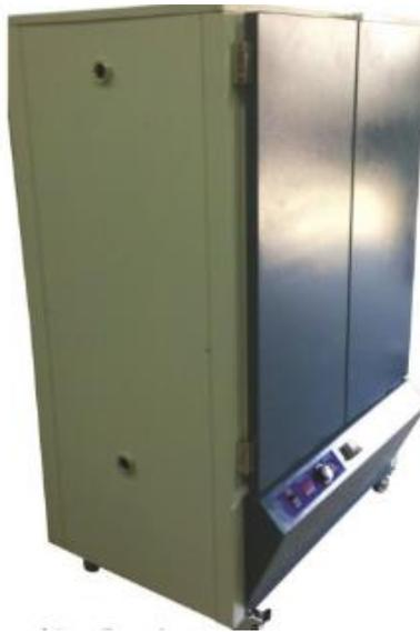
Figura 18 - Estufa utilizada para determinação de umidade dos produtos.
