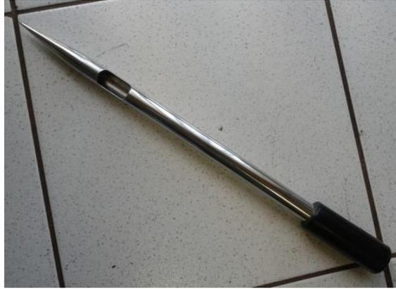
Figura 16 - Calador para retirada de amostra de produtos em sacarias.
