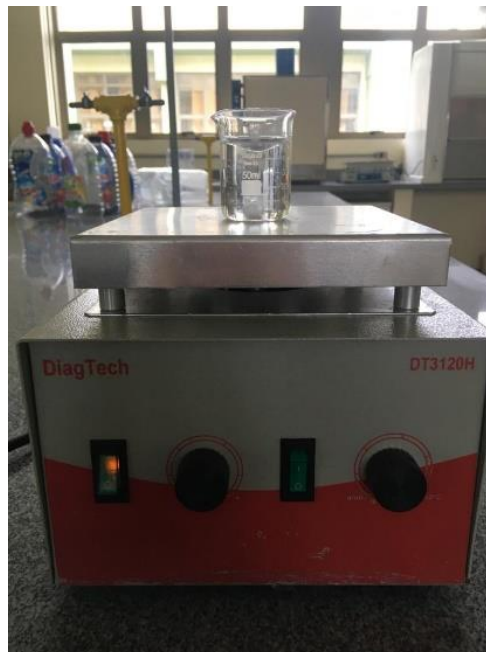
Figura 19 – Processo de lavagem das microesferas por meio de agitador magnético
