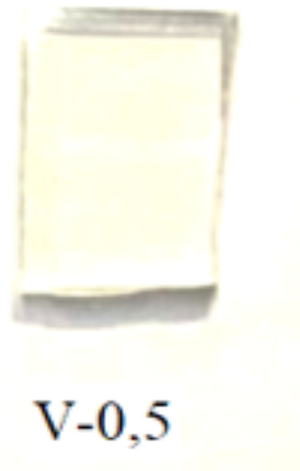
Figura 29 – Imagem do vidro produzido utilizando CCA, com óxido de antimônio
