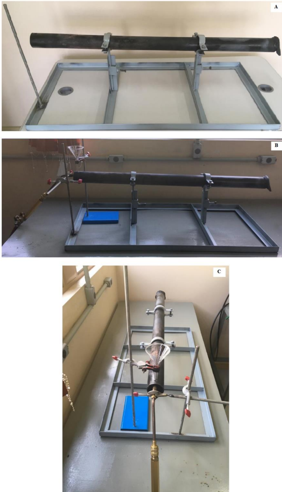
Figura 18 – Base metálica do aparato experimental (A); Aparato Experimental para obtenção de microesferas instalado vista frontal (B); Vista lateral (C)
