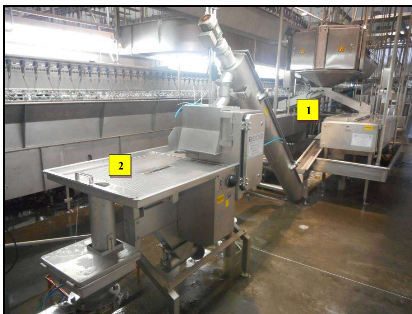
FIGURA 13 - Processamento da moela 1 – Máquinas realizam abertura e lavagem; 2 – “rolinho” que remove a cutícula (Fonte: O Autor).
