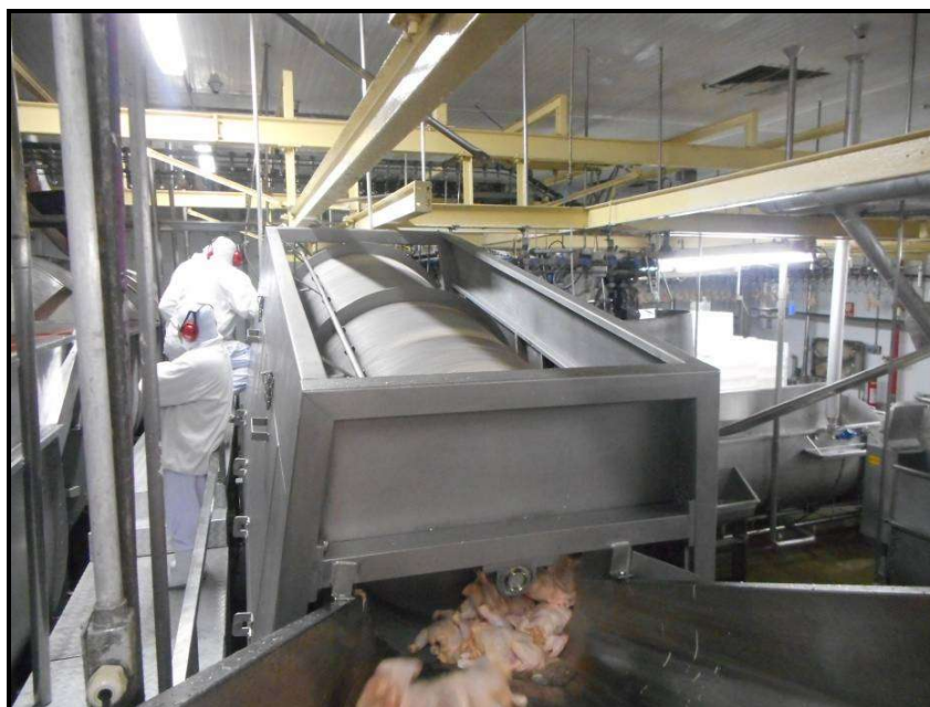
FIGURA 16 - Peneira de gotejamento da linha 1 (Fonte: O Autor).
