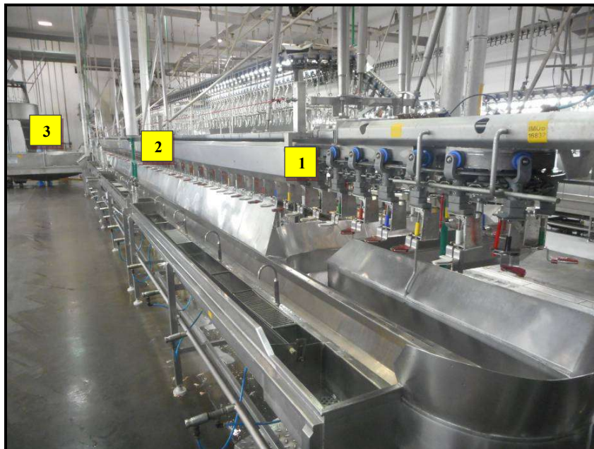
FIGURA 14 - Separação manual de vísceras da linha 2 1 – retirada do coração; 2 – retirada do fígado; 3 – retirada e abertura automática da moela (Fonte: O Autor).
