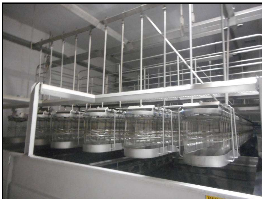
FIGURA 6 - Túnel da sangria. As aves após sangria devem permanecer por no mínimo 3 minutos para o escoamento completo do sangue antes de iniciar as outras etapas (Fonte: O Autor).
