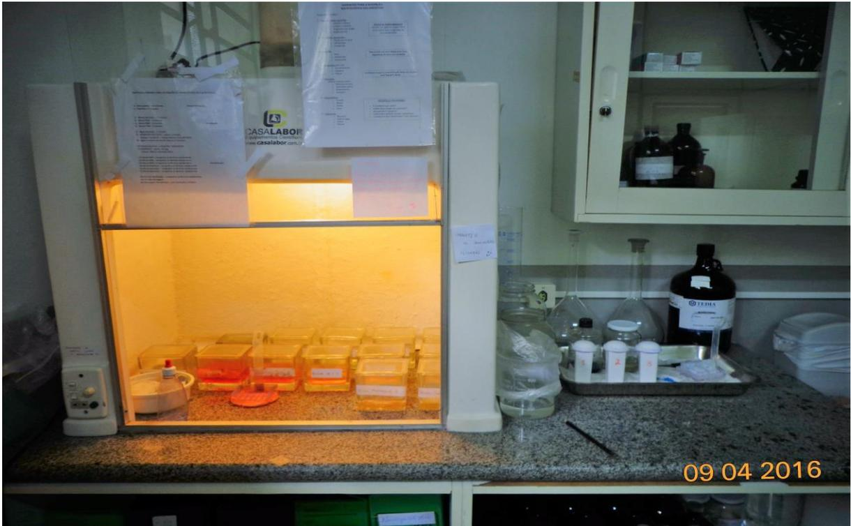
FIGURA 3 – Capela exaustora com bateria de reagentes para coloração de hematoxilina e eosina.
