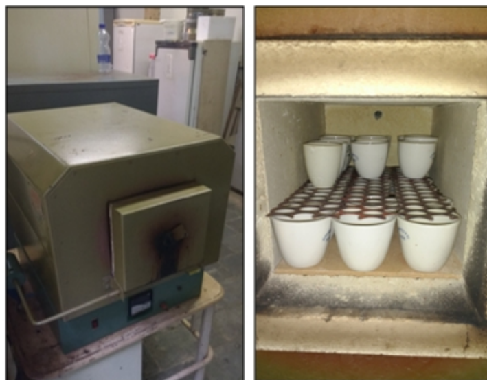
Figura 36- Amostras sendo colocadas na mufla para obtenção de cinzas.
