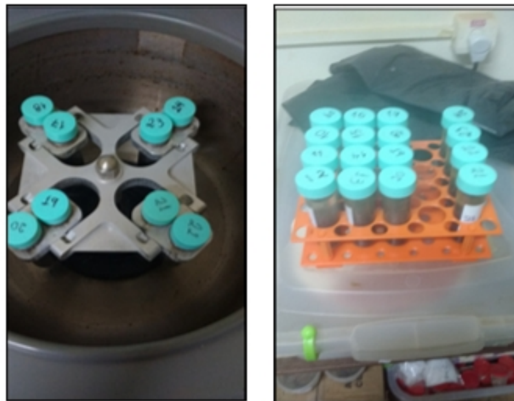
Figura 32- Amostras homogeneizadas e postas na centrífuga.
