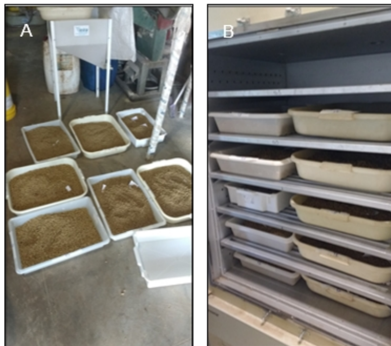
Figura 27- A) Rações separadas em bandejas e B) Rações postas na estufa a 55°C.
