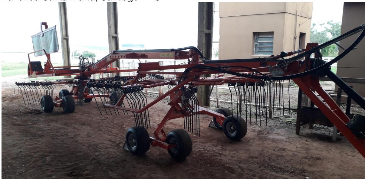
Figura 7 – Enleirador marca Kuhn® utilizado na fabricação de pré-secado na Fazenda Santa Marta, Santiago - RS
