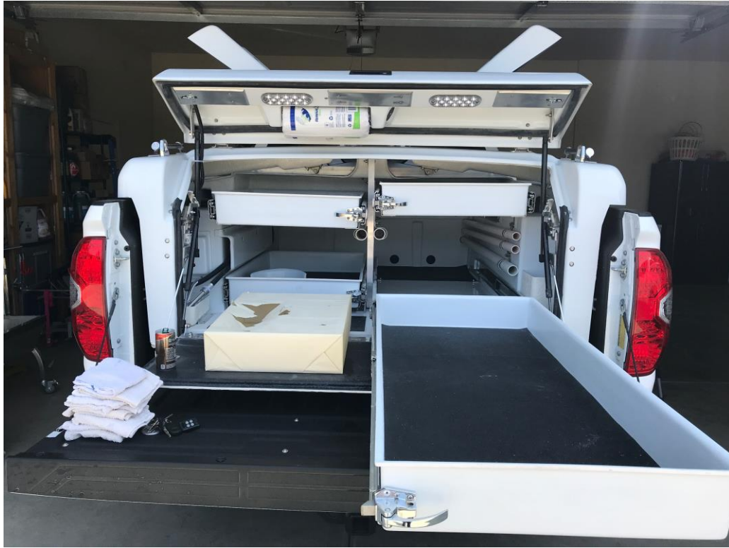
FIGURA 3 – Clínica móvel acoplada à caçamba de camionete do tipo pick-up.
