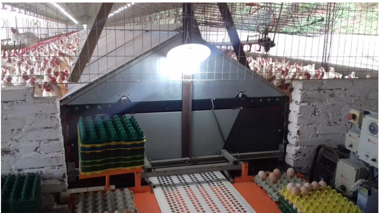
FIGURA 15 - Esteira para recolhimento de ovos no ninho automático.
