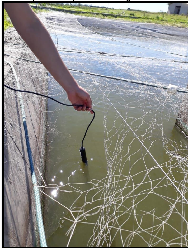
Figura 21. Medição de temperatura e Oxigênio dissolvido na água
