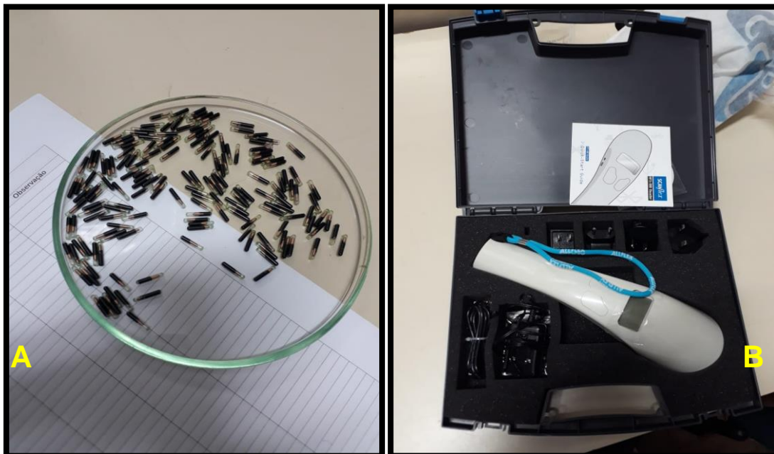
Figura 9. Microchips (A) e Escâner (B) utilizados na chipagem
