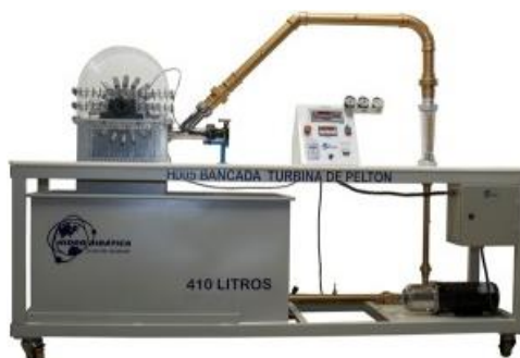
Figura 2 - Bancada de treinamento de turbina Pelton
