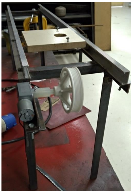
Figura 17 - Sistema de fixação do motor elétrico
