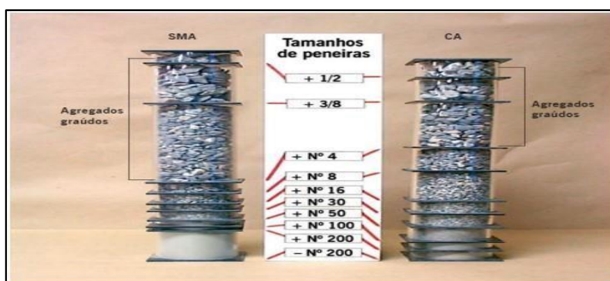
Figura 3 – Composições granulométricas comparativas entre um SMA e um CA
