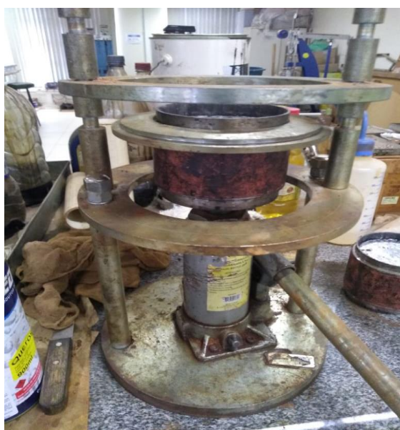
Figura 7 – Desmoldagem dos corpos de prova
