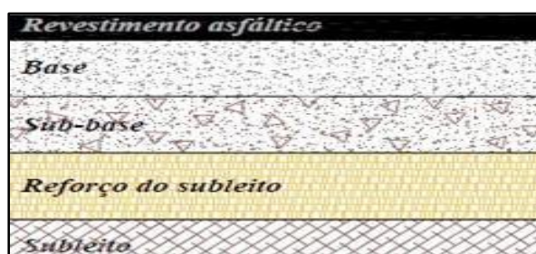
Figura 1 – Camadas do Pavimento Flexível
