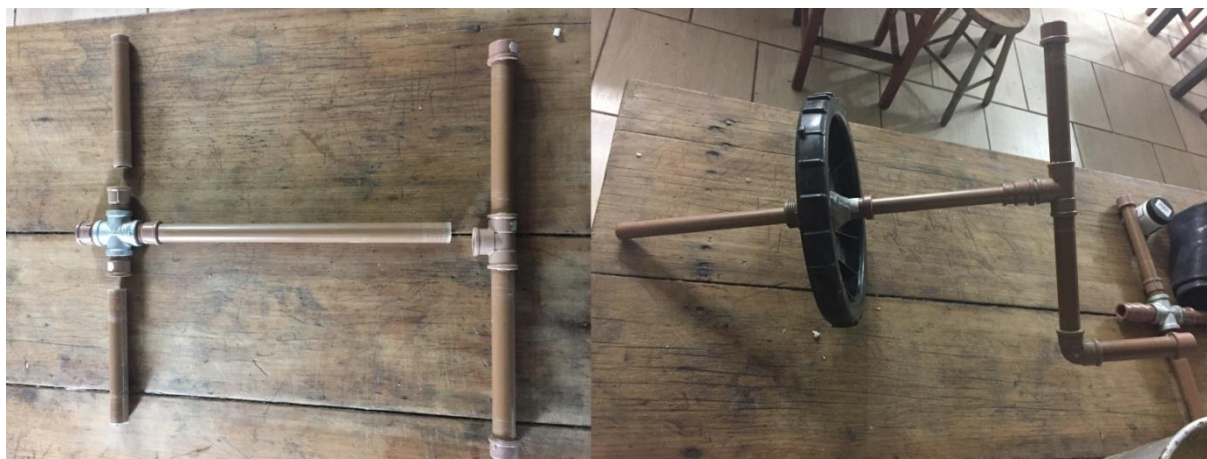
Figura 3- Misturador, parte interna e externa, respectivamente, com a manivela.
