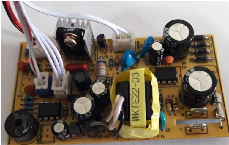
Figura 9 - Circuito gerador de sinal do umidificador utilizado.
