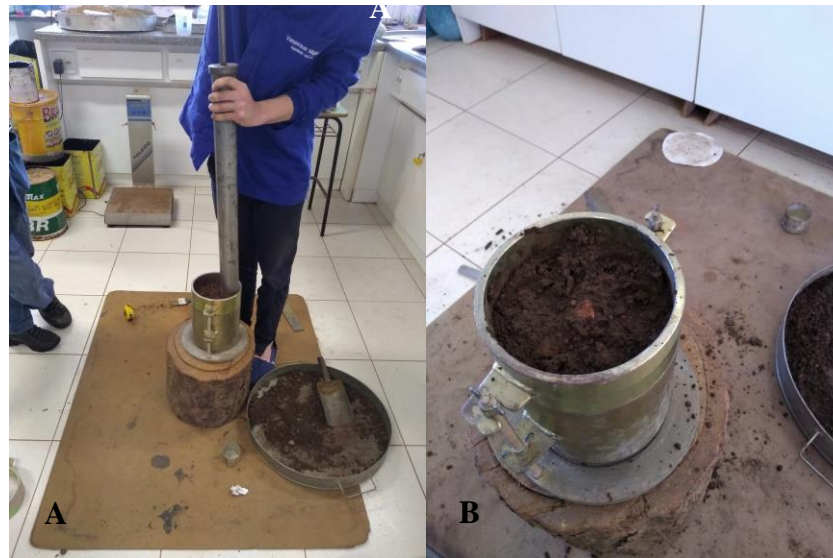
Figura 12 – Ensaio de Compactação. A) Compactação sendo realizada. B) Conjunto compactado. Fonte: Própria.
