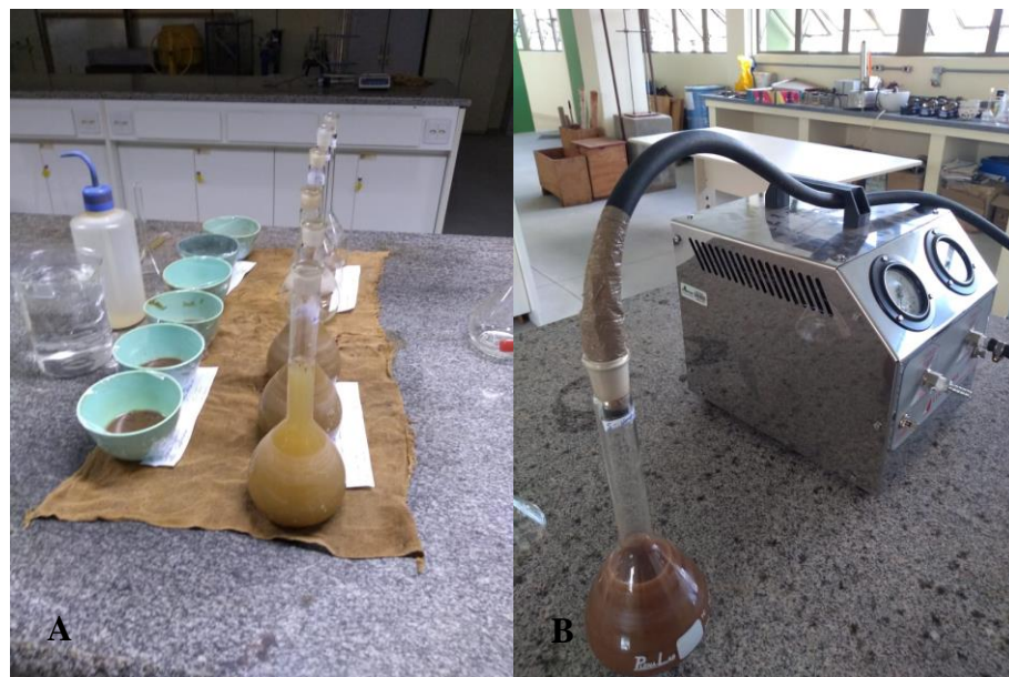
Figura 11 – Ensaio de massa específica. A) Ensaio de Massa específica. B) Picnômetro sendo submetido a vácuo.
