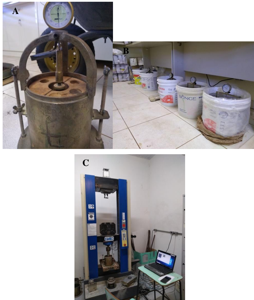
Figura 13 – Ensaio de ISC e Expansão. A) conjunto cilindro CBR montado para o ensaio de expansão. B) Conjuntos de Corpos de provas imersos em água durante o ensaio de expansão. C) Prensa hidráulica automatizada realizando o ensaio de ISC.
