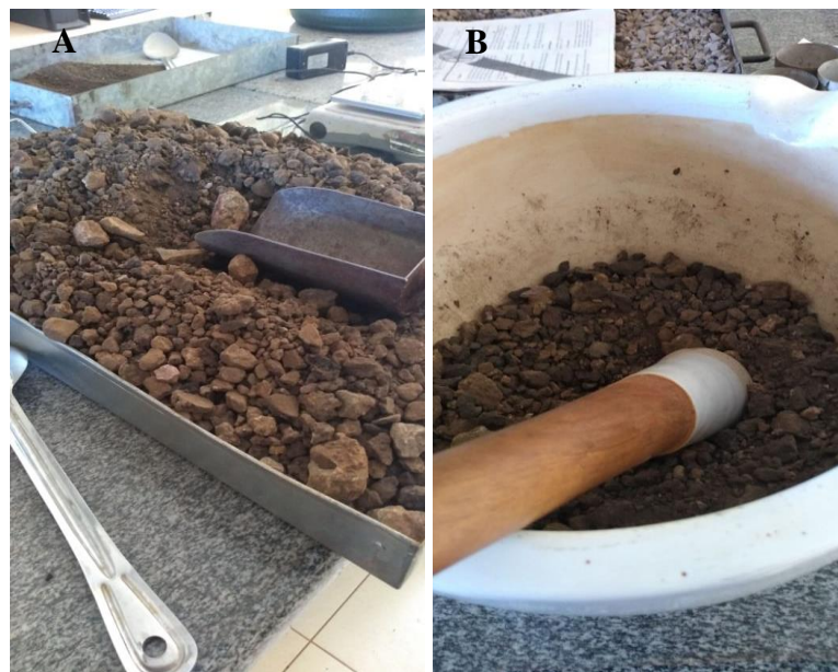
Figura 8 – Preparação de Amostras. A) Bandeja com solo. B) Amostra sendo destorroadada no Almofariz. Fonte: Própria.
