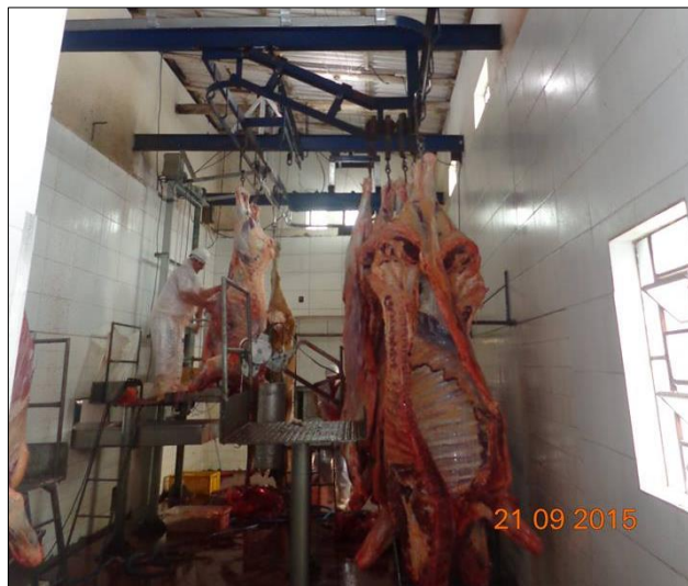
Figura 6 - Evisceração (as carcaças dos animais são abertas manualmente com facas e com serra elétrica)
