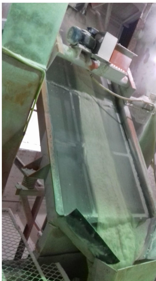
Figura 1 - Material concentrado no leito central da peneira vibratória e forte inclinação da peneira
