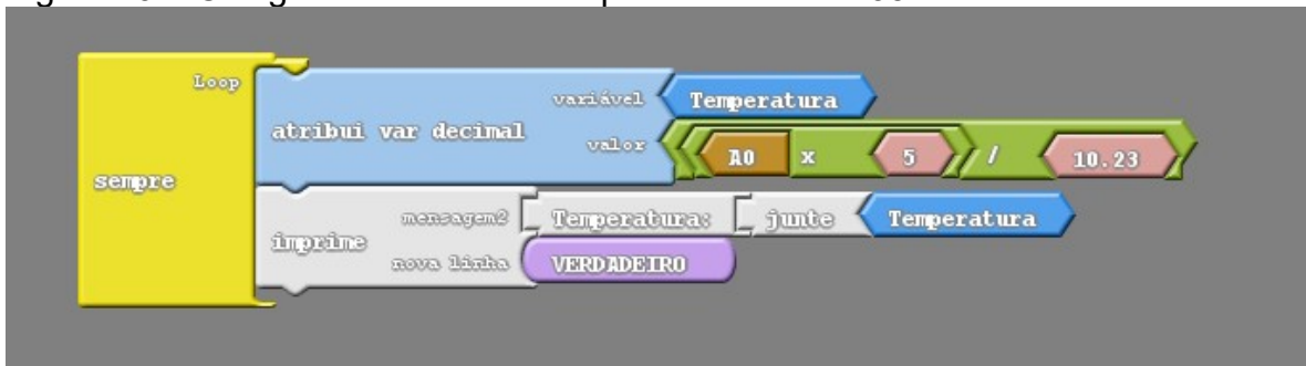
Figura 49 – Código da medida de temperatura com LM35
