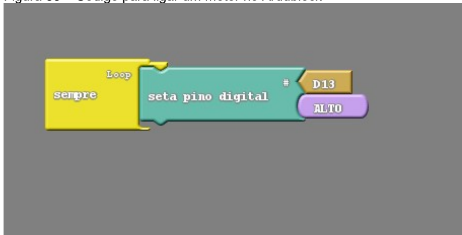
Figura 53 – Código para ligar um motor no Ardublock
