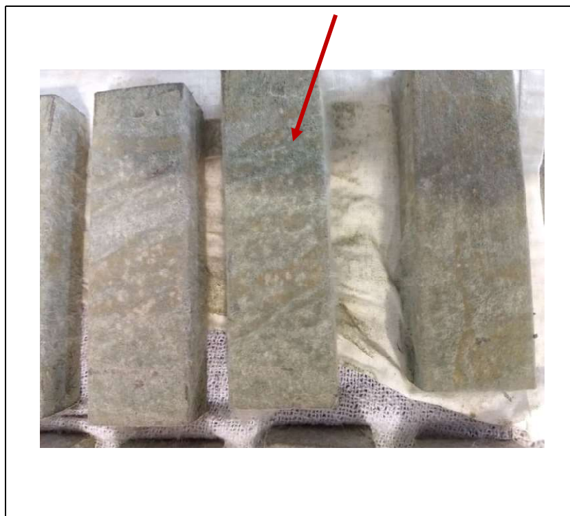
Figura 18 – Presença de mofo nos CPs
