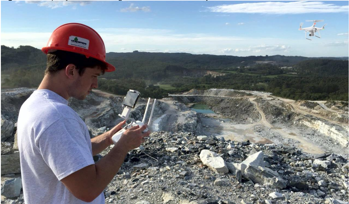
Figura 12 – Aquisição de aerofotografias utilizando VANT Dji Phantom 4 PRO.
