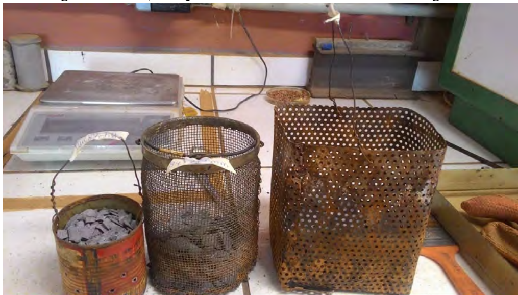
Figura 12 – Foto exemplificando o ensaio de sanidade, os quais as amostras são separadas de acordo com seu tamanho de brita e colocadas de molho em uma mistura de água e sulfato, completando 5 ciclos entre molho e secagem.
