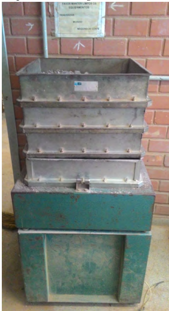
Figura 9 – Foto do agitador usado para a separação granulométrica após as amostras passarem pelo processo de britagem
