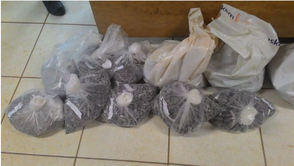
Figura 10 – Foto das amostras separadas após processo de britagem e separação granulométrica. Estão separadas de acordo com a bancada em que foram coletadas e de acordo com seu tamanho de brita.
