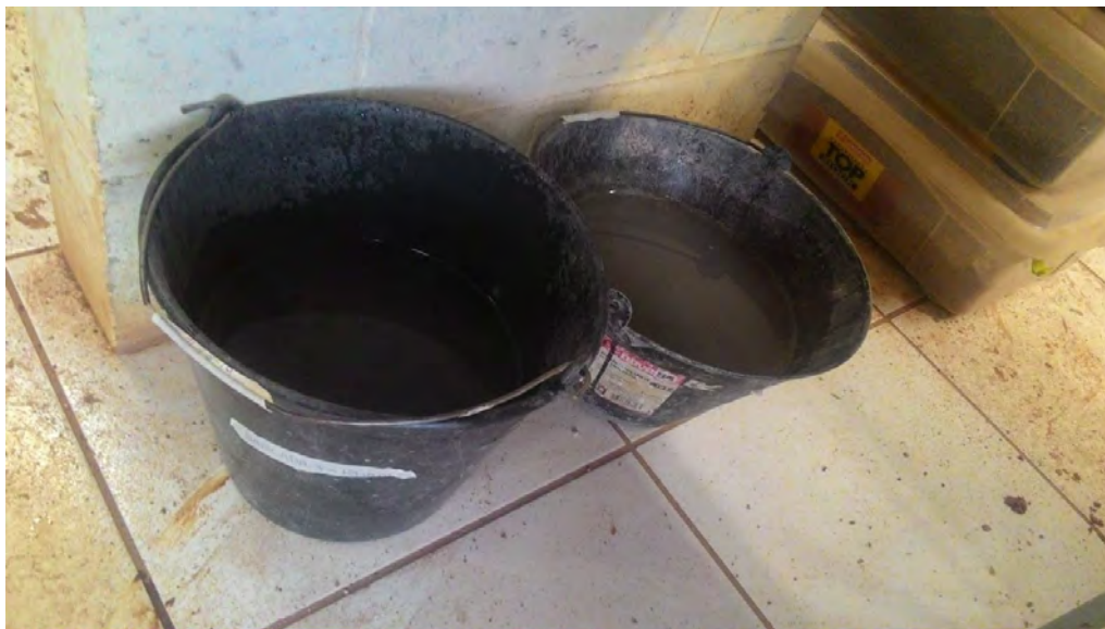
Figura 11 – Foto exemplificando o ensaio de absorção, os quais as amostras são deixadas de molho em baldes.
