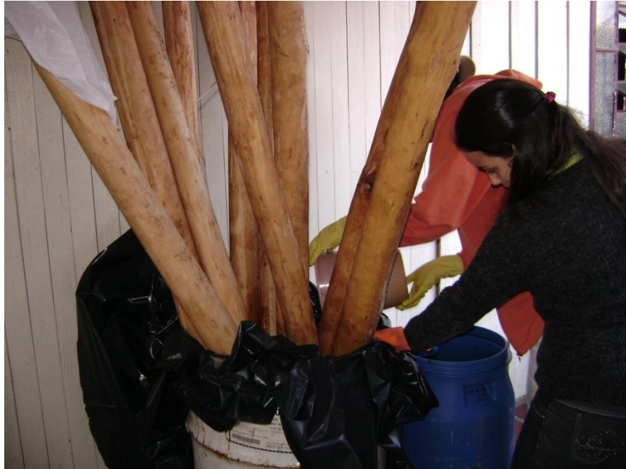
FIGURA 3 – Adição da solução ao tonel com os moirões.
