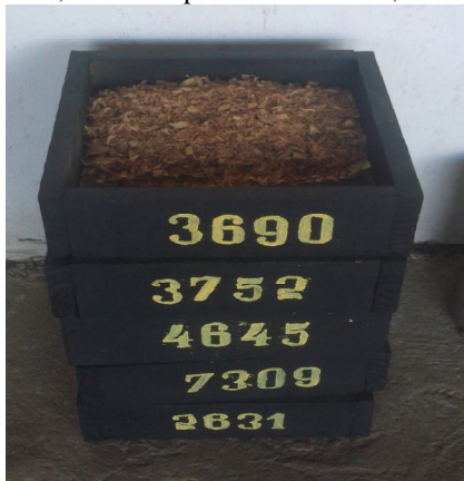
Figura 24 - Caixas de recolhimento de vazamentos de óleo das viaturas, no 9º RCB, no município de São Gabriel, RS.
