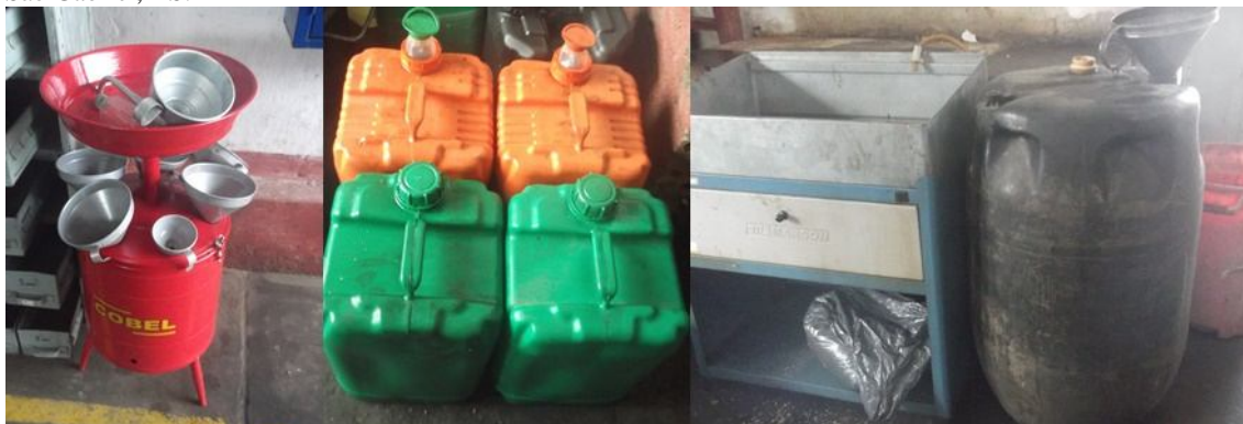
Figura 25 - Sistemática atual de recolhimento e armazenamento de óleo lubrificante, no 9º RCB, no município de São Gabriel, RS.
