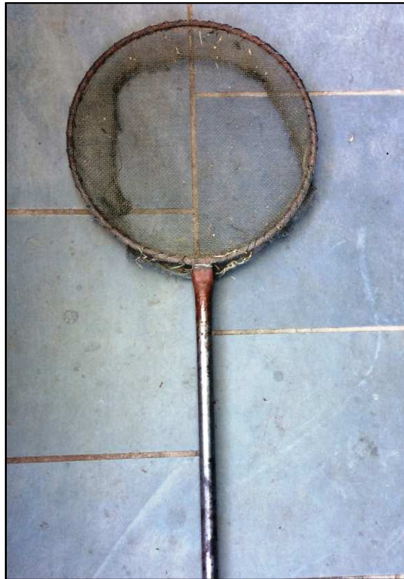
Figura 2. Rede de amostragem, puçá de cabo longo, com rede de malha metálica de 3mm 2 , utilizado para coleta de larvas de Odonata.
