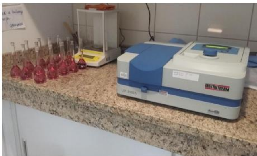
Figura 9: Espectrofotômetro utilizado na quantificação dos índices de polifenóis totais.
