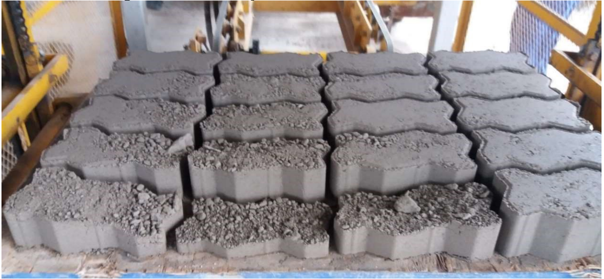
Figura 54 - Distribuição cônica dos materiais na matriz
