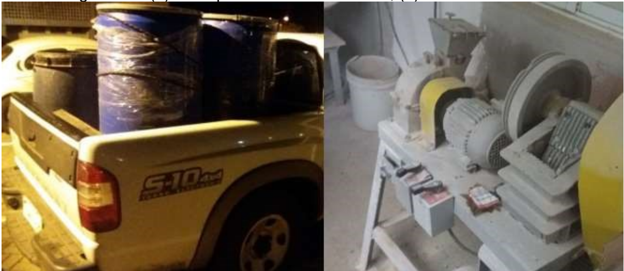
Figura 31 - (a) Transporte do Vidro Triturado; (b) Moinho de Martelo
