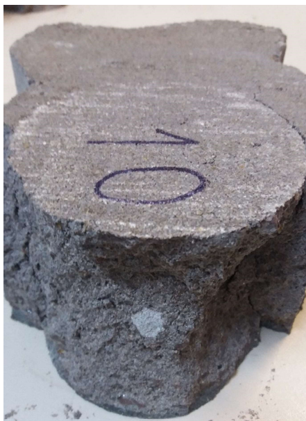
Figura 52 - Exemplo de Defeito encontrado no Paver
