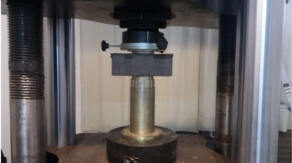
Figura 51 - Dispositivo de Ensaio com diâmetro de 85mm
