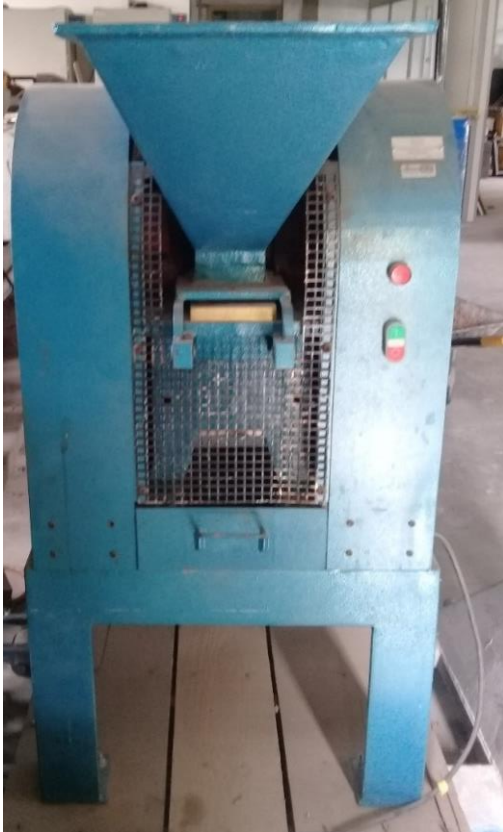
Figura 9 – Britador de mandíbula.
