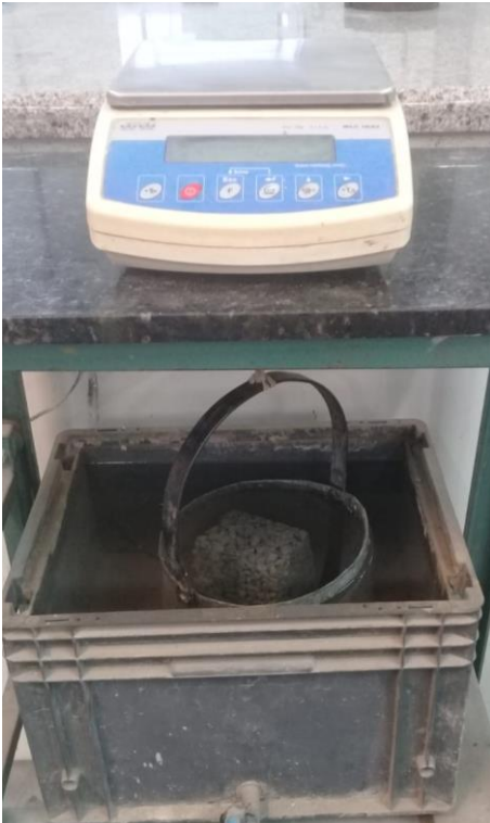
Figura 15 – Procedimento para obtenção da massa submersa
