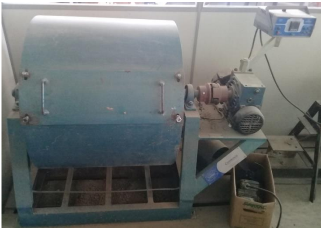
Figura 19 – Máquina de abrasão Los Angeles.
