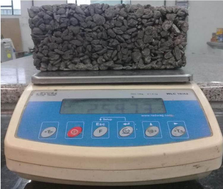
Figura 14 – Procedimento para obtenção da massa seca
