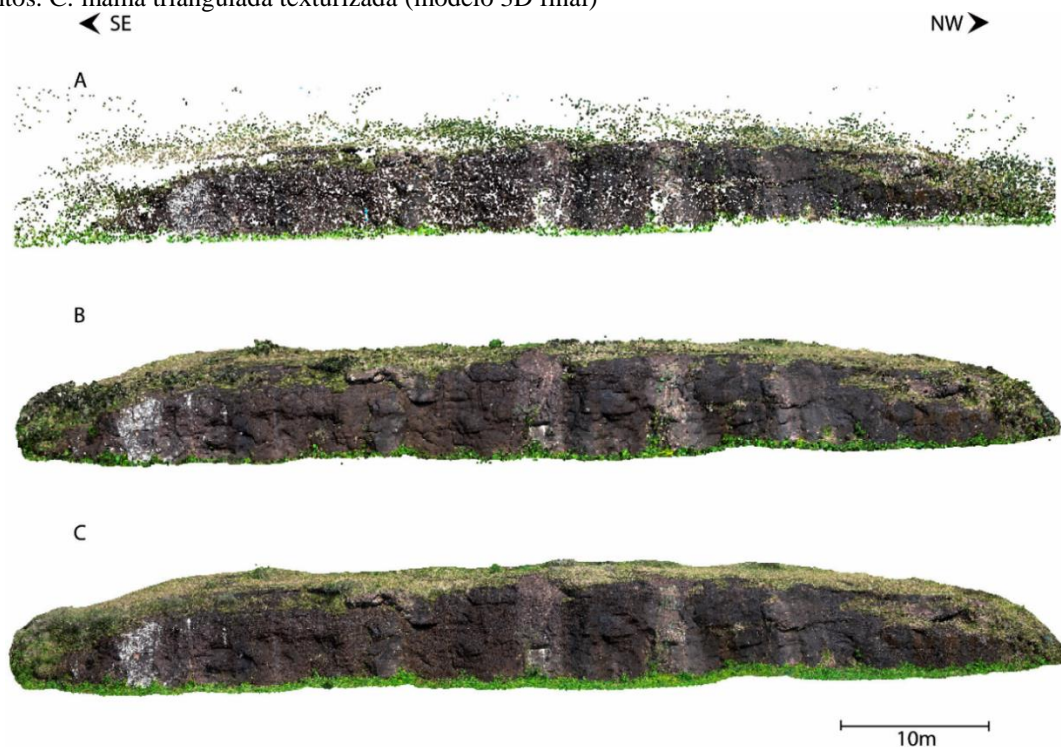
Figura 14 - Etapas de processamento do MVA do afloramento CE-2. A: nuvem esparsa de pontos. B: nuvem densa de pontos. C: malha triangulada texturizada (modelo 3D final)
