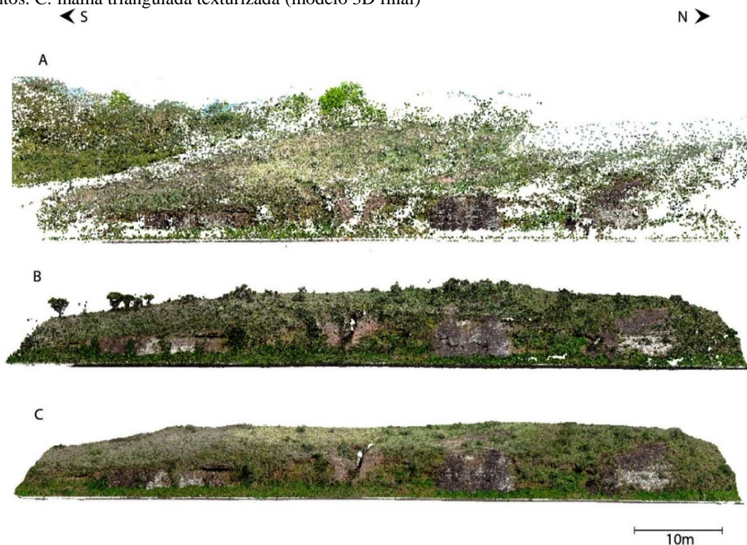
Figura 13 - Etapas de processamento do MVA do afloramento CE-1. A: nuvem esparsa de pontos. B: nuvem densa de pontos. C: malha triangulada texturizada (modelo 3D final)
