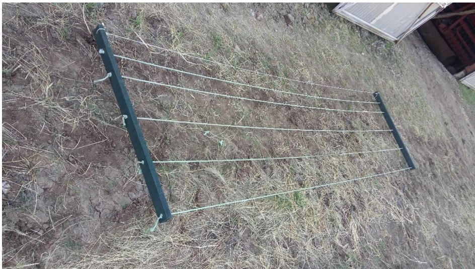
Figura 9 – Estrutura de madeira e cordas utilizada para determinação de perdas na colheita mecanizada da soja.
