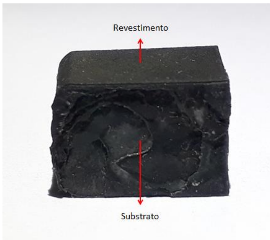
Figura 31 - Amostra de carbeto de cromo após ciclagem térmica em 900°C
