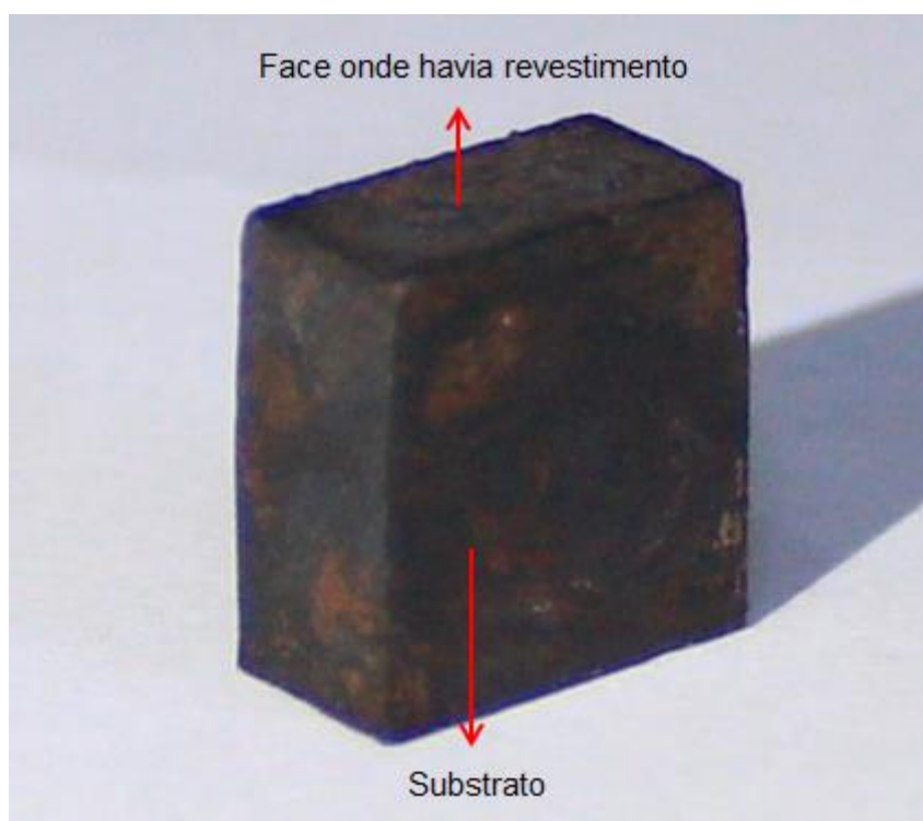
Figura 32 - Amostra de carbeto de tungstênio após ciclagem térmica em 900°C
