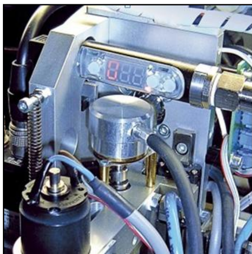
Figura 16: Detalhe de instalação do sensor de pressão.
