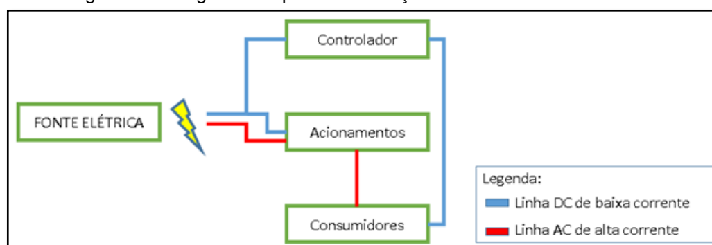
Figura 22 – Diagrama simplificado das ações em termos de rede elétrica.
