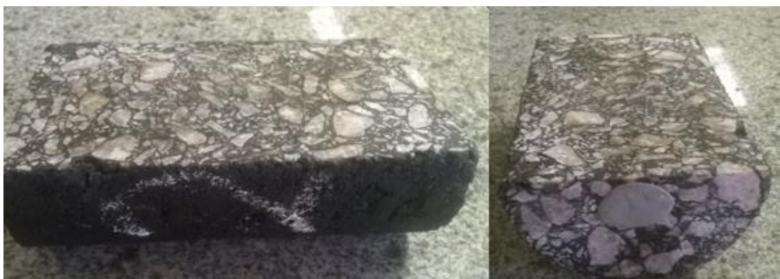
Figura 16 - Amostras cortadas longitudinalmente
