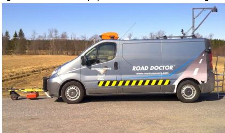
Figura 4 - Veículo equipado com câmera termográfica
