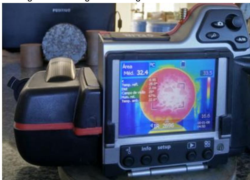
Figura 18- Fotografia termográfica de uma amostra
