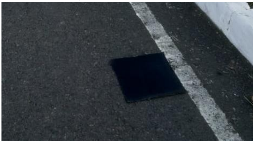
Figura 21 - Determinação da emissividade do revestimento asfáltico
