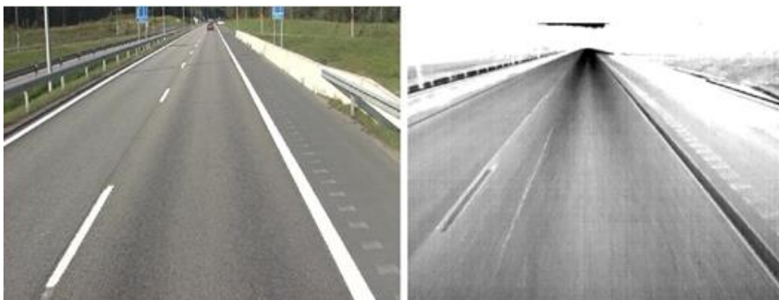
Figura 10 - Detecção de trinca com câmera termográfica
