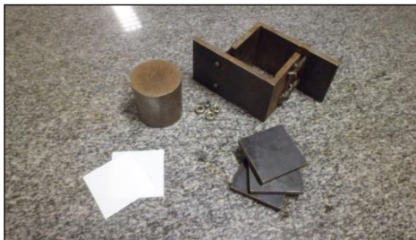
Figura 29 - Molde metálico utilizado na confecção dos corpos de prova
