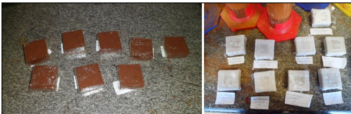
Figura 32 - Corpos de prova de solo protegidos para armazenagem
