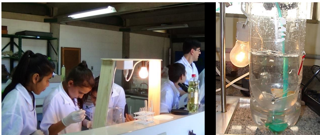
Figura 2- Aparato para a eclosão dos cistos Fonte: Autoria própria.
