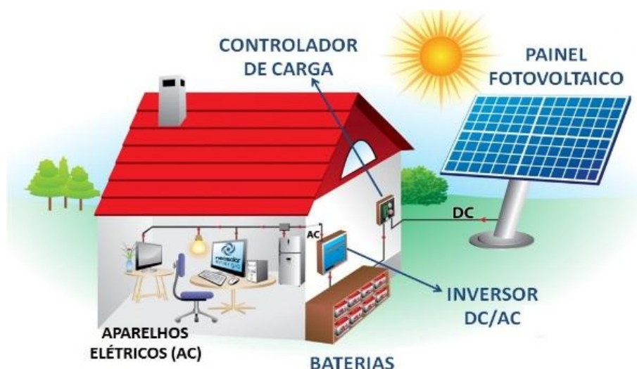
Figura 2.10 – Exemplo de um sistema fotovoltaico Off-grid .
