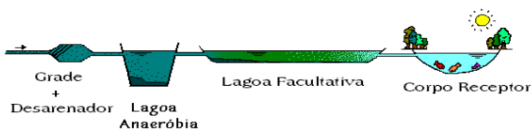
Figura 2 - Esquema de sistema de lagoa anaeróbica – lagoa facultativa
