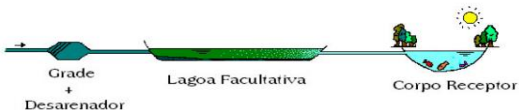
Figura 1 - Esquema de sistema com lagoas facultativas
