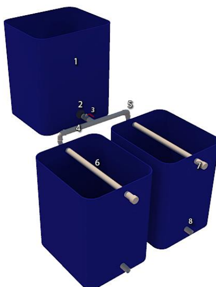
Figura 13 - Esquema representativo do sistema experimental com wetlands construídos
