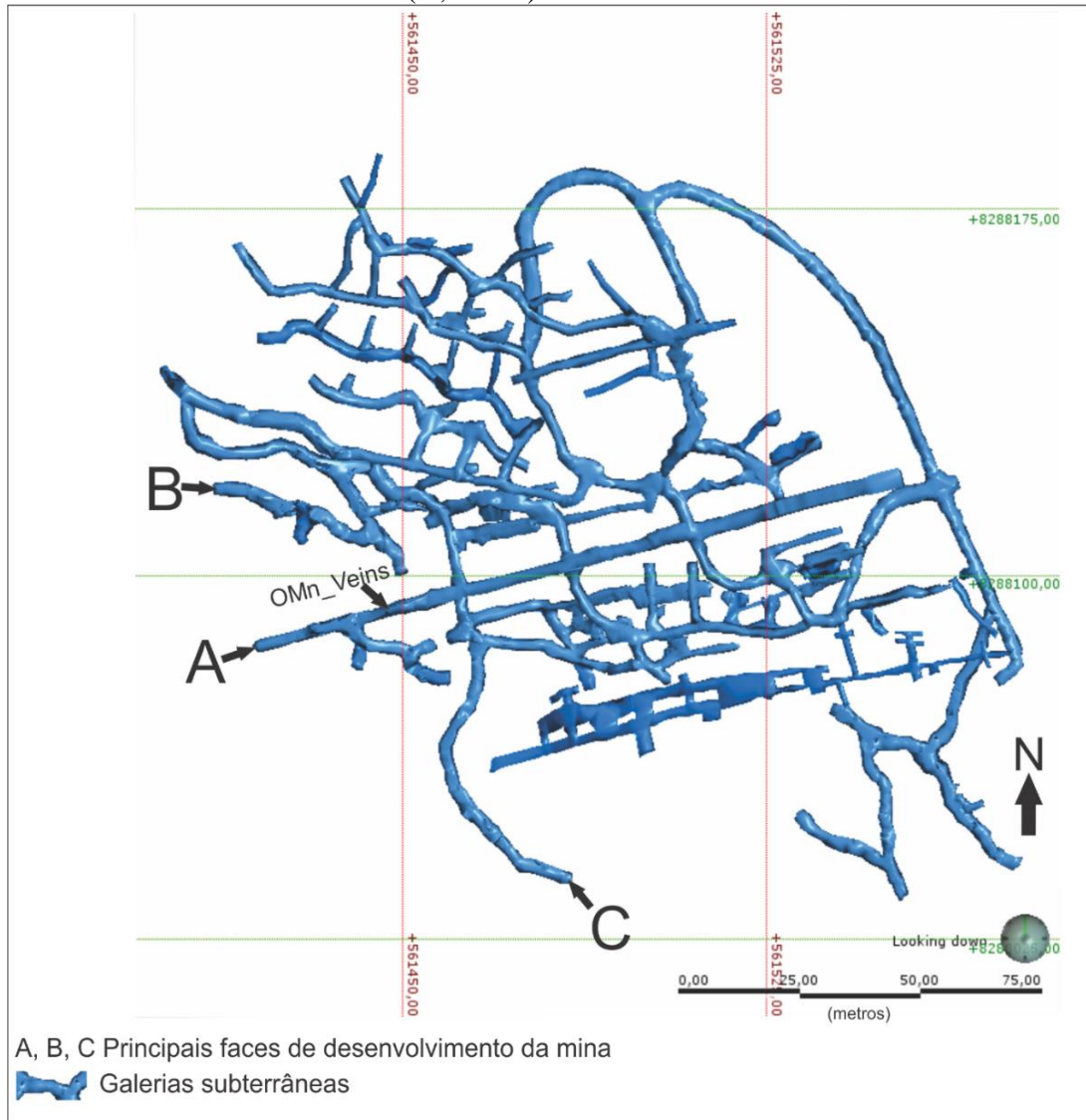
Figura 3 - Galerias subterrâneas da mina Cascavel e indicação da localização da percolação de água nas faces de desenvolvimento (A, B e C).
