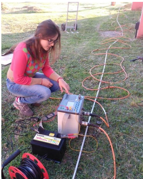
Figura 20 - Resistivímetro Syscal Pro, unidade de aquisição, bateria, multicabos de conexão e eletrodos.
