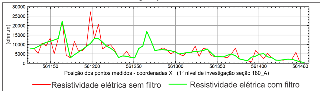
Figura 28 - Gráfico com os valores de resistividade elétrica do primeiro nível de investigação (vermelho) e resistividade elétrica com aplicação do filtro (verde).
