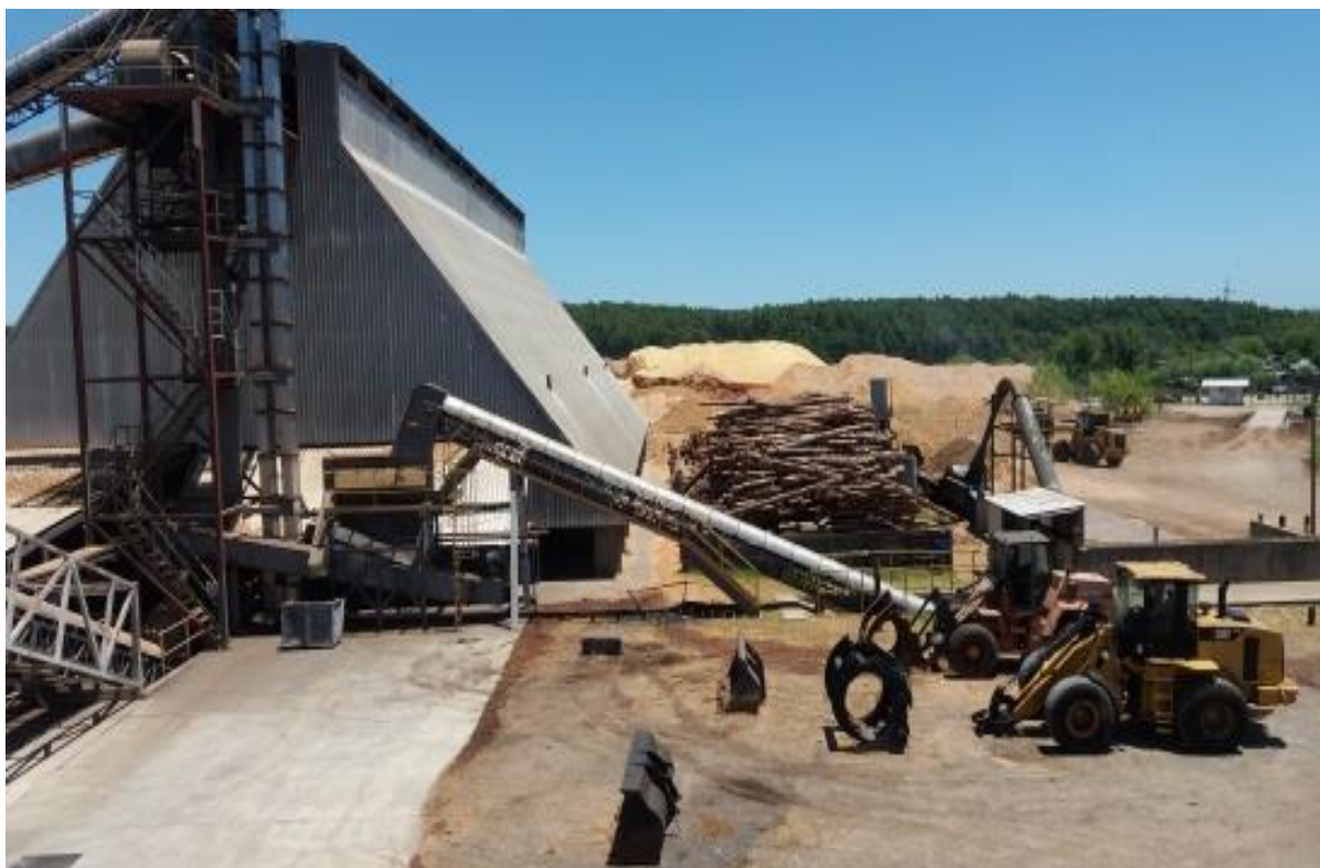
Figura 10 - Material, troncos, trituradora, tremonha, esteira, peneira 1 e silo de úmidos
