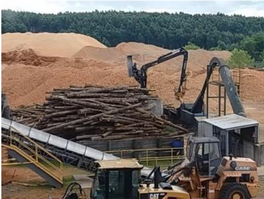
Figura 11 - Detalhe de troncos e trituradora em operação
