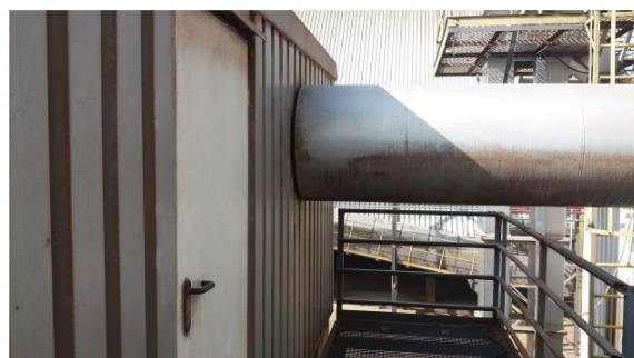
PARTE EXTERNA, VAPOR ENTRANDO NO SECADOR
