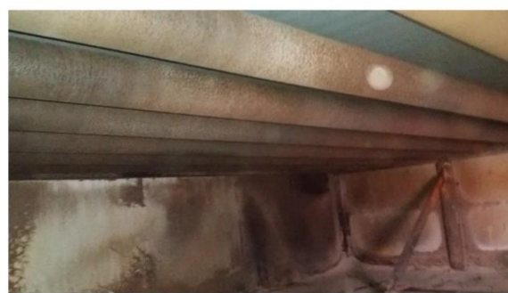
VISTA INFERIOR: ESTEIRA DO SECADOR QUE CARREGA BIOMASSA PELO AMBIENTE DOS TROCADORES
