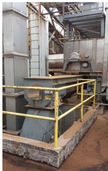
Figura 18 - Elevador de canecas do secador para a peneira vibratória
