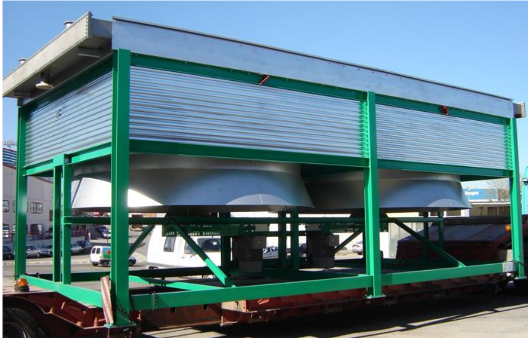
Figura 8 - Exemplo de um aerocondensador
