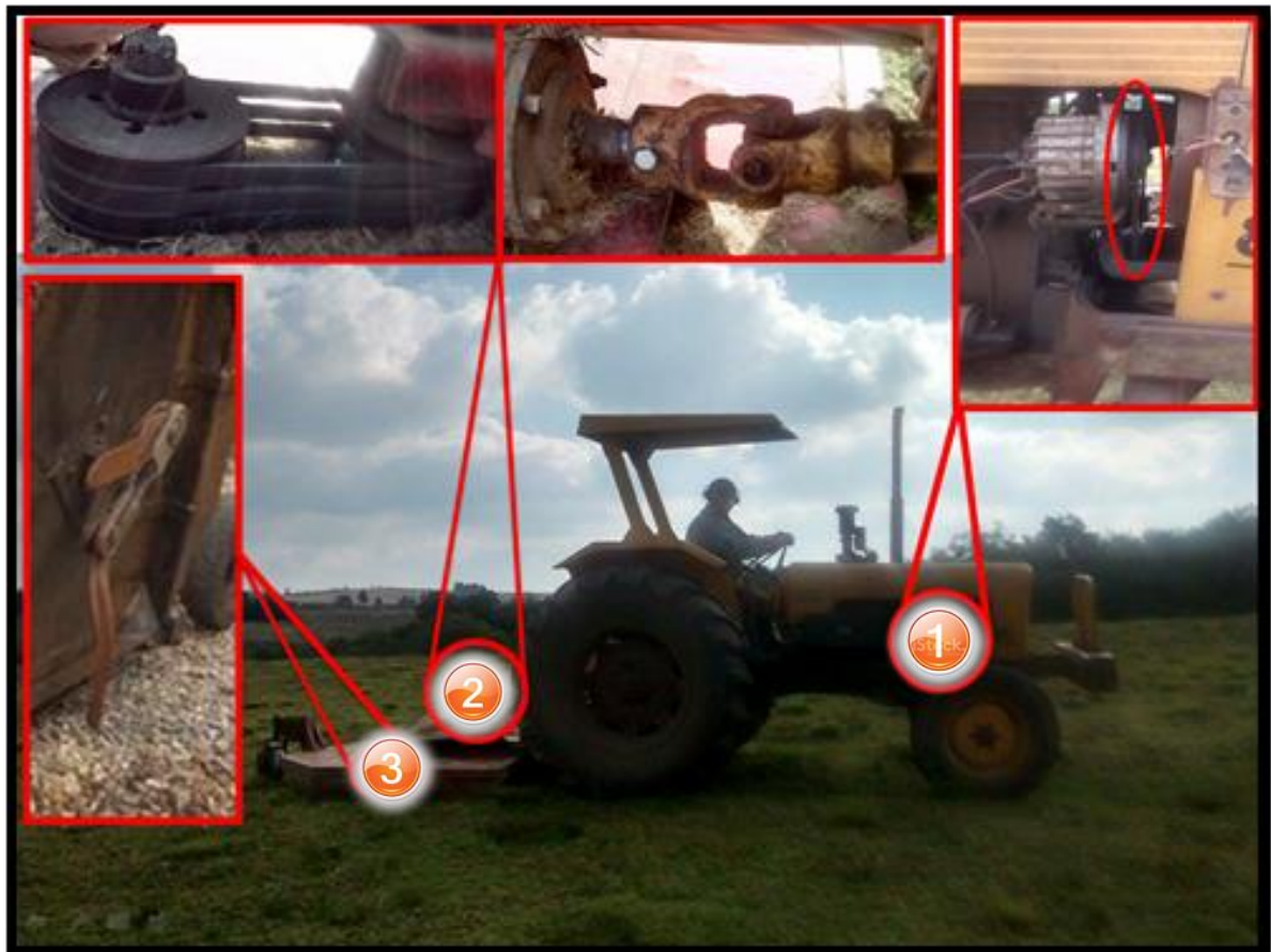
Figura 28 – Partes do Trator com alta rotação: polias, facões e tomada de força
