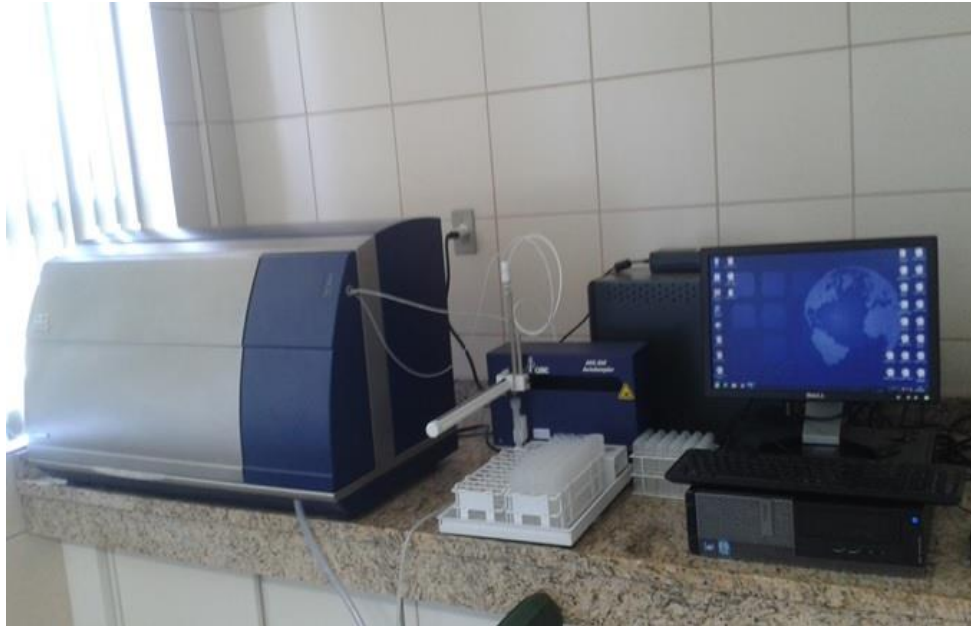
Imagem 10 – WineScan - espectrometria de infravermelho por transformada de Fourier (FTIR)
