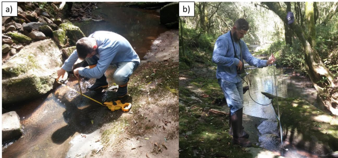
Figura 31 - Coleta dos dados para obtenção da vazão SM-VZ-01, a) contagem dos pulsos captados pelo molinete fluviométrico, b) medição da seção transversal com trena e régua.
