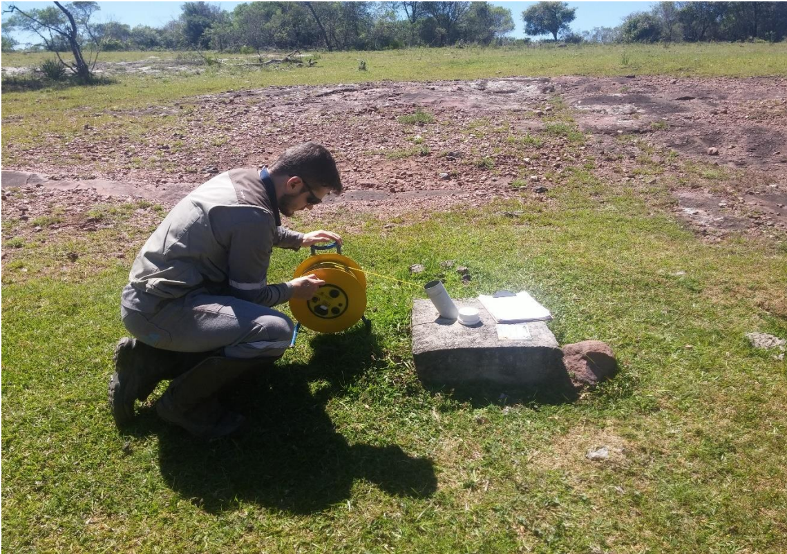
Figura 17 - Utilização do Pna-300 para medição do nível d'água.
