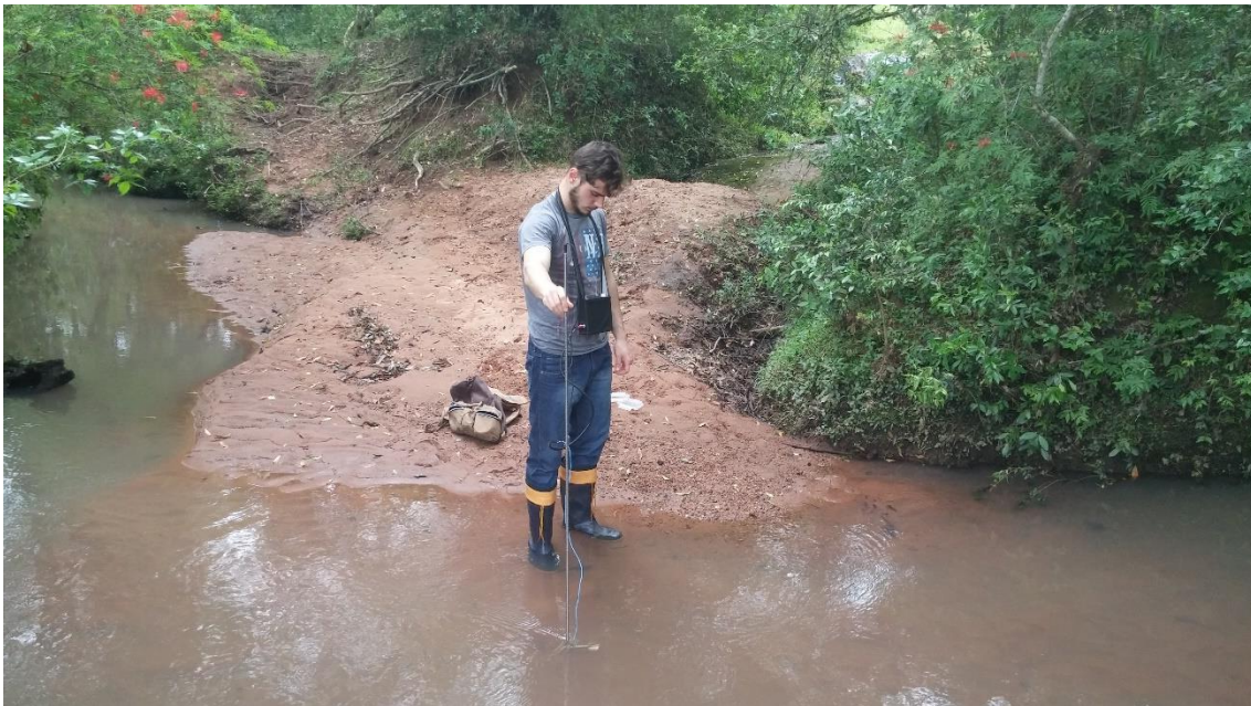
Figura 32 - Obtenção dos dados de velocidade e tamanho da seção para determinar a vazão no ponto SM-VZ-15.
