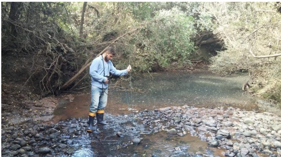
Figura 23 - Medição da velocidade da água com molinete fluviométrico do ponto SM-VZ-13.
