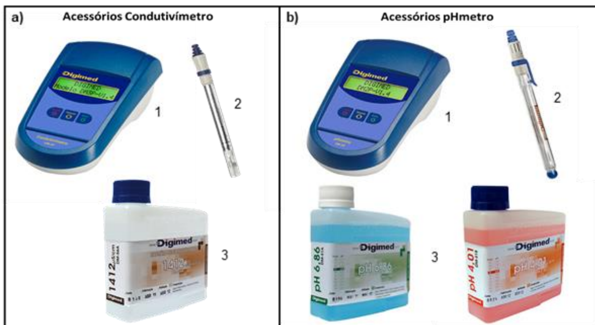
Figura 16 - Equipamentos necessários para realização da coleta de dados dos parâmetros físico-químicos. a) o condutímetro (1) com o eletrodo (2) e a solução de condutividade padrão (3), em b) pHmetro (1) com o eletrodo (2) e os tampões de pH (3).
