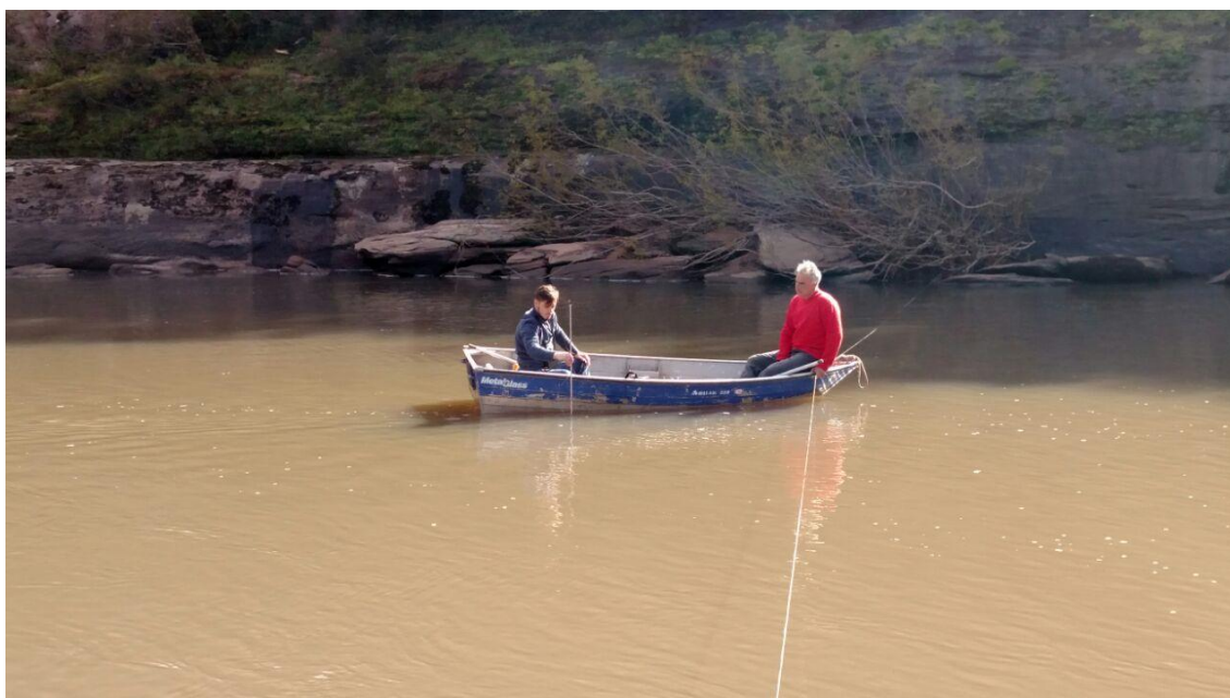
Figura 21 - Medição dos pulsos captados pelo molinete fluviométrico, assim como a medição da seção transversal no Rio Camaquã.
